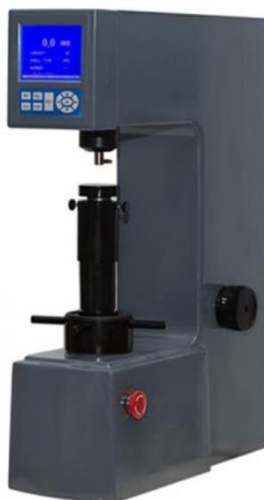
Рисунок 2.4 – Общий вид твердомера Роквелла Wilson Hardness 574T
