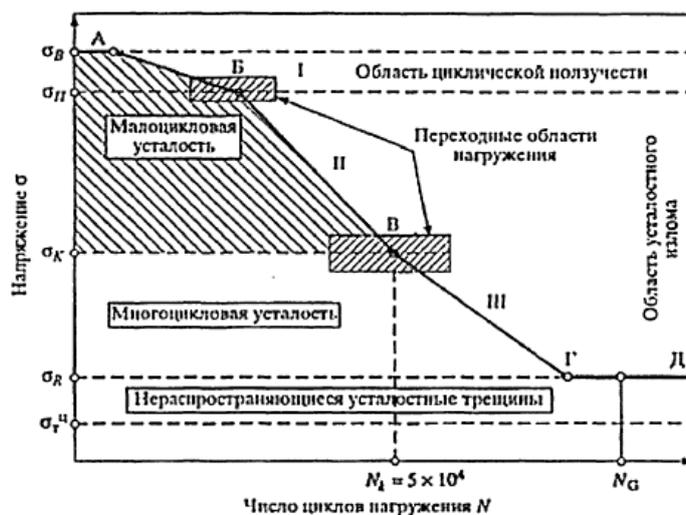
$\sigma_B$  – предел прочности;  $\sigma_{II}$  – напряжение разрыва;  $\sigma_K$  – критическое напряжение;  $\sigma_R$  – предел усталости;  $\sigma_{TII}$  – циклический предел текучести;
