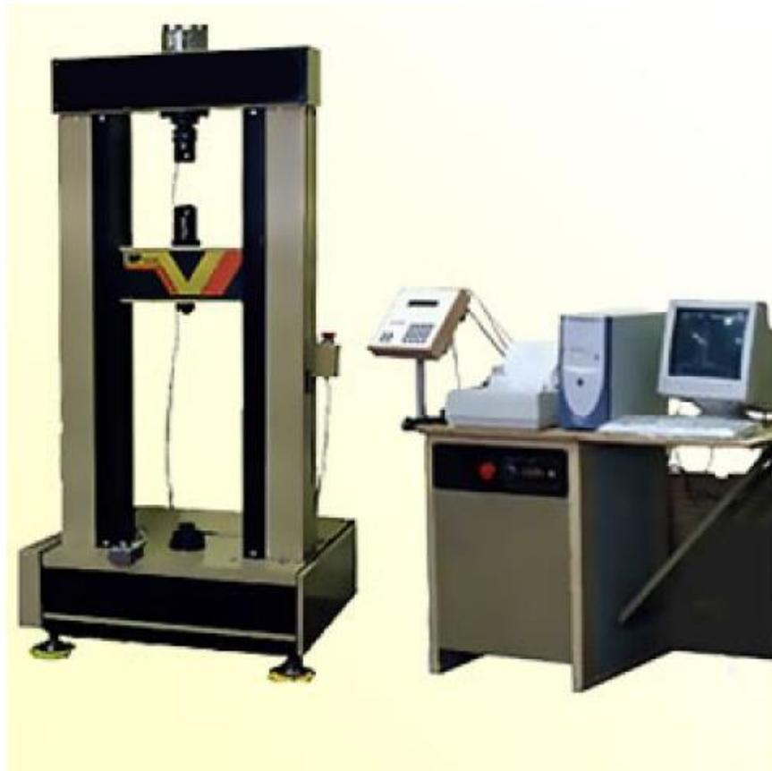
Рисунок 2.3 – Динамометрическая разрывная машина ИР5113
