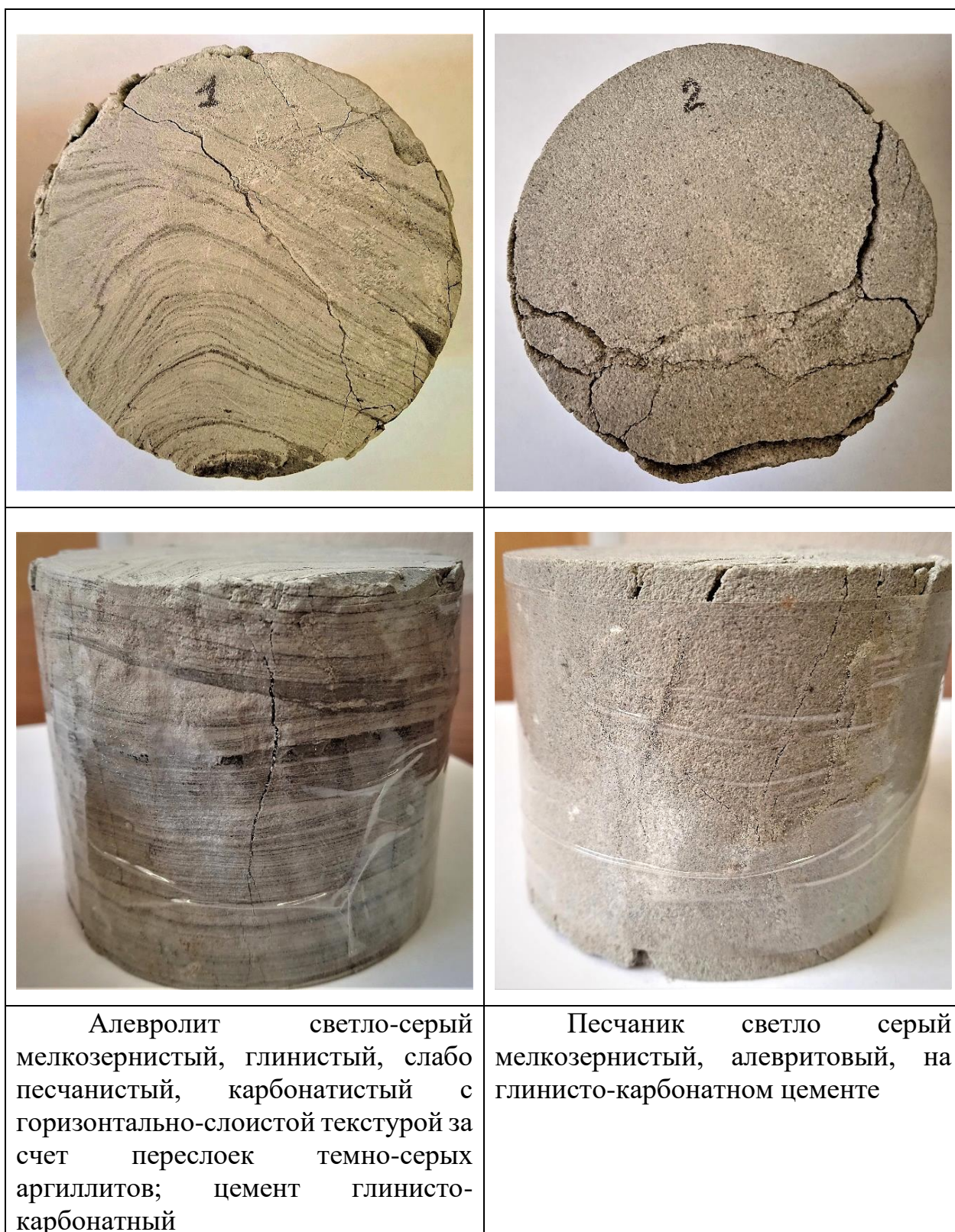
Рисунок 3.3 – Определение деформационно – прочностных характеристик керна (Ловинская площадь)
