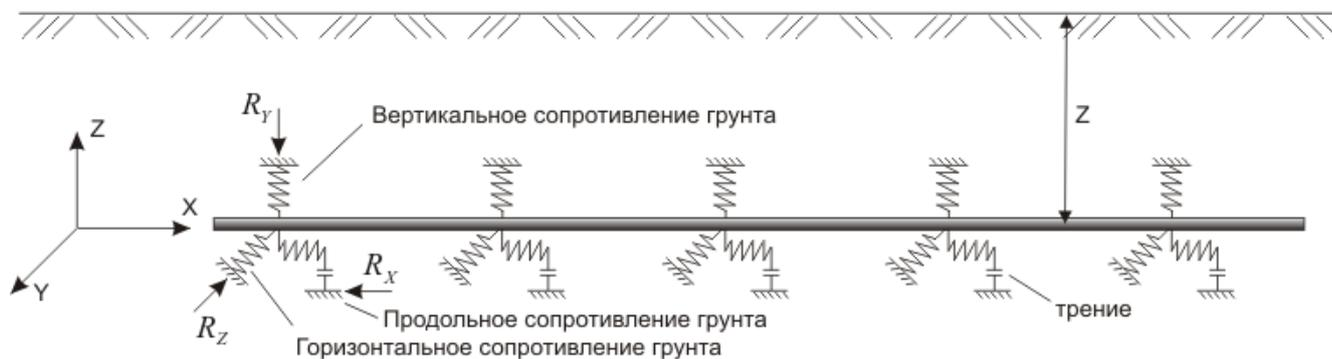
Рисунок 2 – Механическая модель труба-грунт
