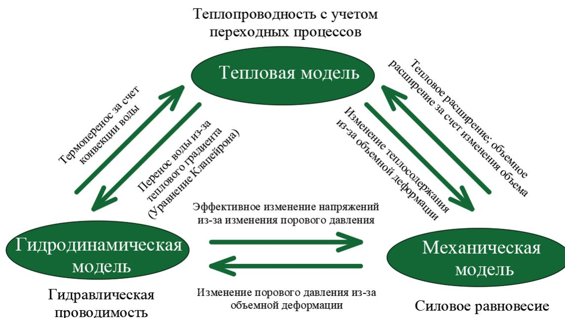
Рисунок 1 – Взаимодействие моделей мерзлого грунта между собой
