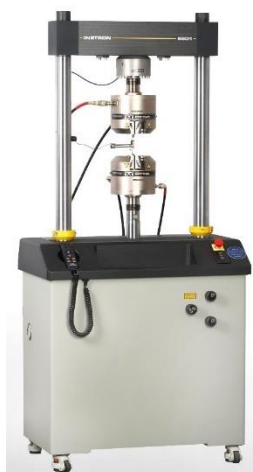
Рисунок 2.11 – Сервогидравлическая испытательная машина для статических и циклических испытаний Instron 8801 [168]
