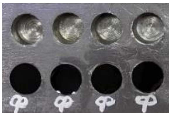
Рисунок 5.7 – Форма для определения усадки и твердости, заполненная композиционным материалом
