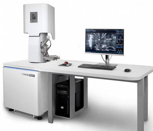
Рисунок 2.22 – Растровый электронный микроскоп Tescan MIRA3 [179]
