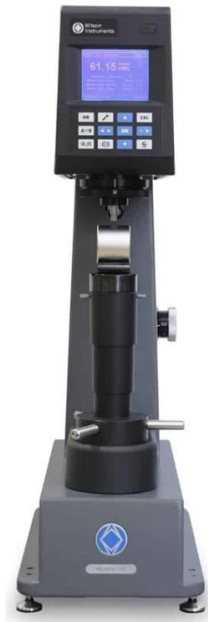
Рисунок 2.12 – Твердомер Wilson Hardness 574Т [170]
