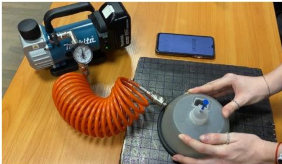
Рисунок 6.5 – Внедрение композиционного материала в полость трещины под действием вакуума
