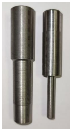
Рисунок 2.20 – Образец для исследования влияния шероховатости на адгезионную прочность соединения композиционного материала с металлом
