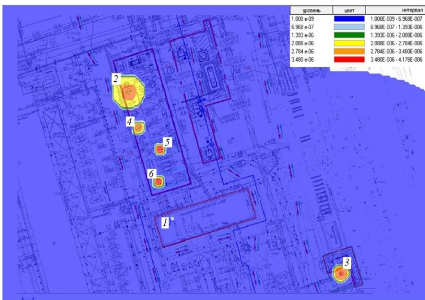
Рисунок 8 – Ситуационный план аварийной ситуации при использовании аппарата однократного испарения
