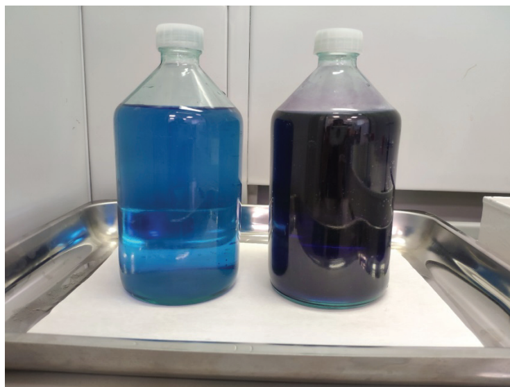
Рисунок 47 – Опытные образцы: вода с разбавленным в ней красителем Романовского-Гимзе: слева с концентраций 0,05%, справа – 0,65%
