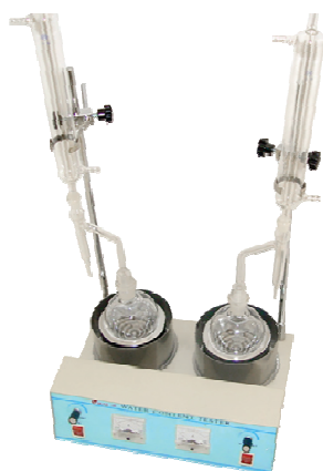
Рисунок 43 –Аппарат для определения содержания воды в нефтепродуктах (метод Дина-Старка)
