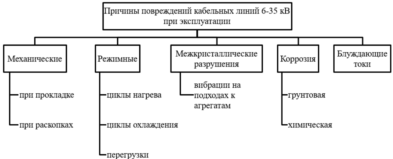
Рисунок 1.7 – Причины повреждений кабельных линий 6-35 кВ при эксплуатации
