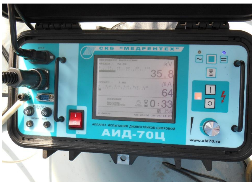
Рисунок 3.11 – Панель прибора для проверки повышенным напряжением
