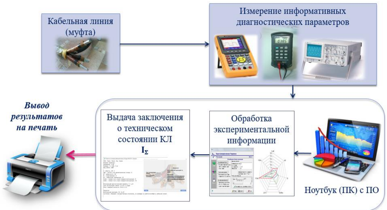
Рисунок 4.3 – Структурная схема комплекса для установления состояния КЛ
