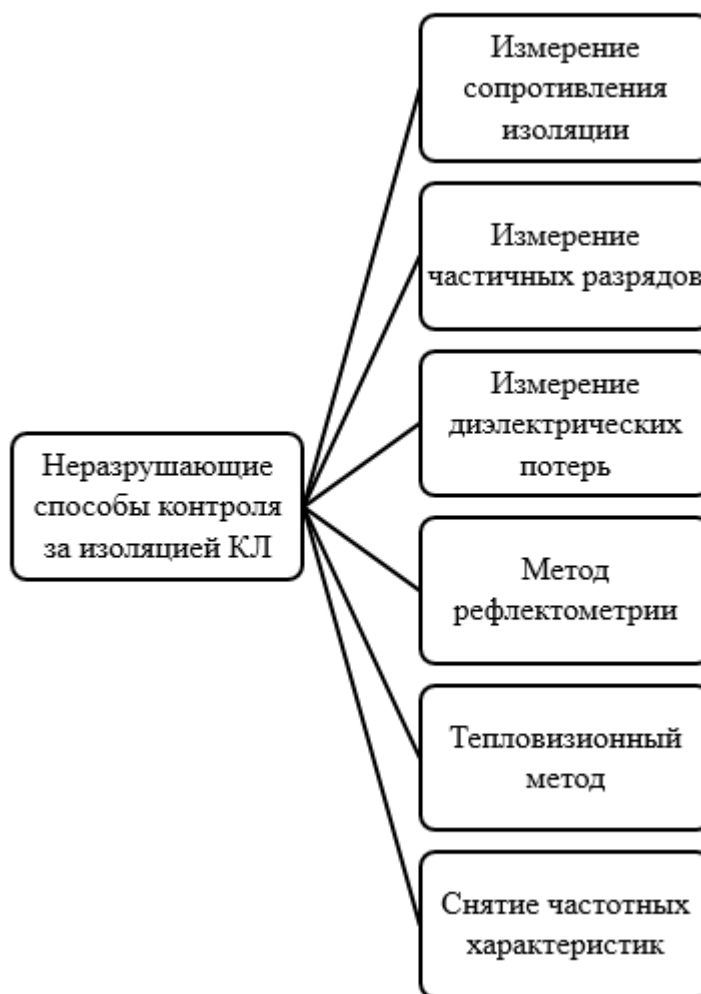
Рисунок 1.12 – Неразрушающие способы контроля за изоляцией КЛ
