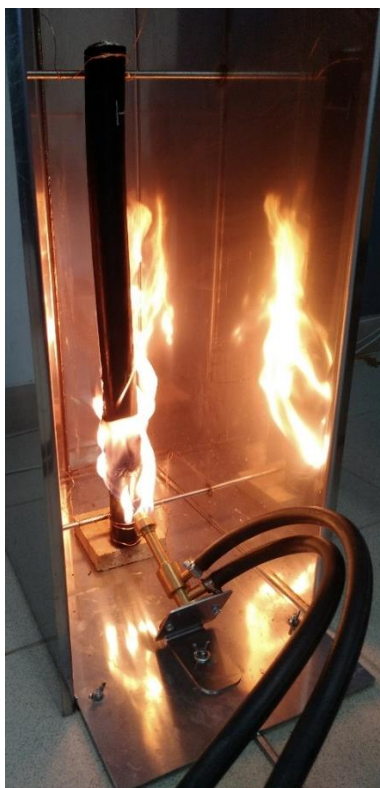
Рисунок 3.28 – Воздействие пламени на кабель ААШв во время испытаний
