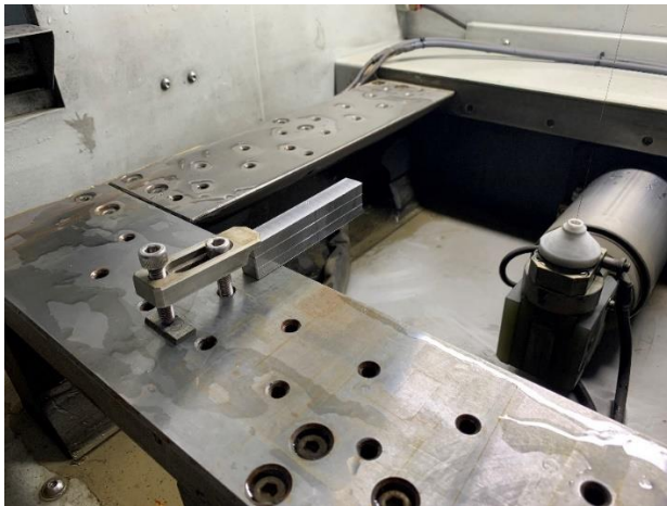
Рисунок 47 – Нанесение трещиноподобных дефектов на образцы
