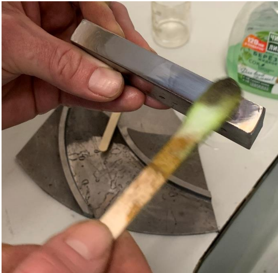
Рисунок 41 – Процесс травления образцов
