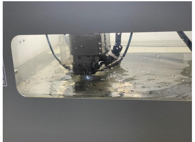
Рисунок 47 – Нанесение трещиноподобных дефектов на образцы
