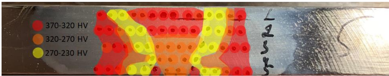
Рисунок 46 – Пример разграничения зон механической неоднородности по показаниям микротвердости (по Виккерсу, HV)
