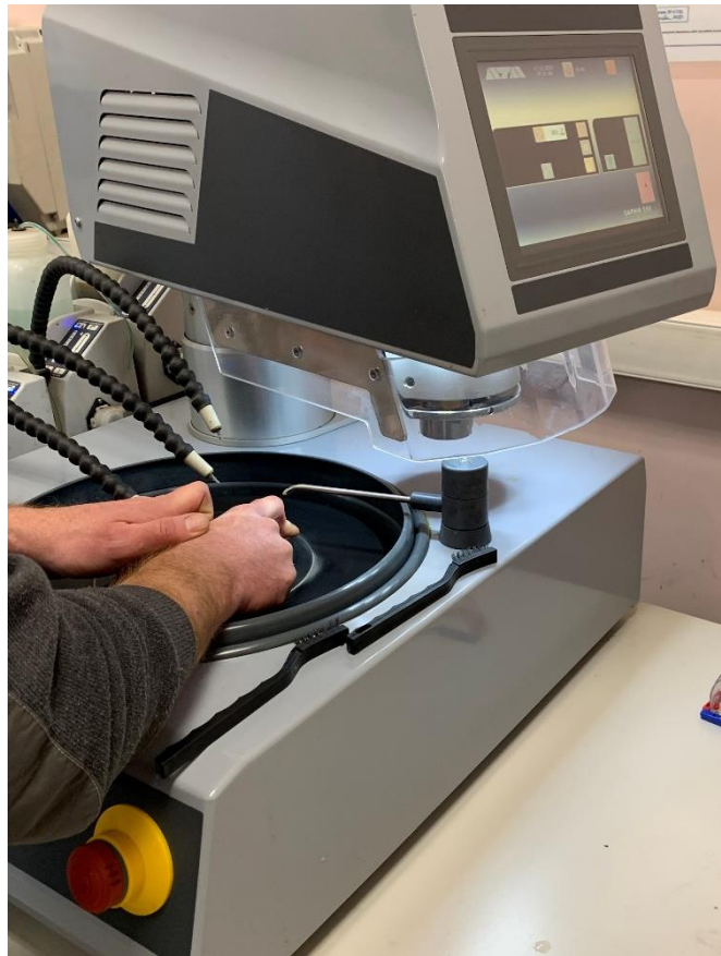
Рисунок 39 – Процесс полировки с применением полировальных материалов
