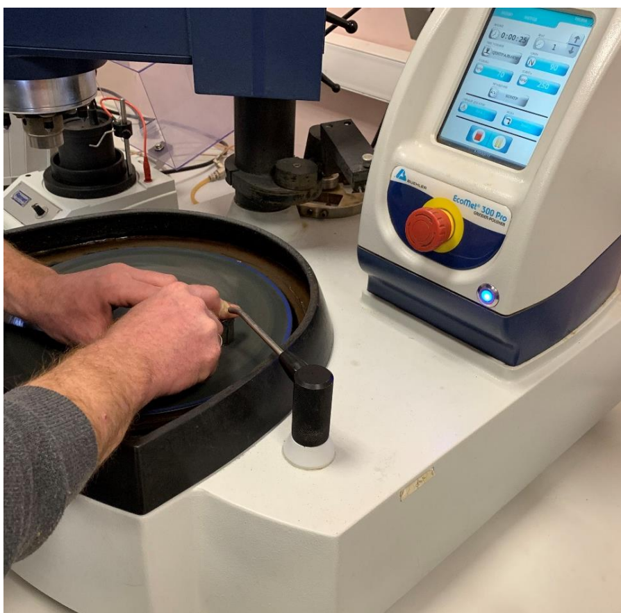
Рисунок 38 – Процесс тонкой шлифовки образцов
