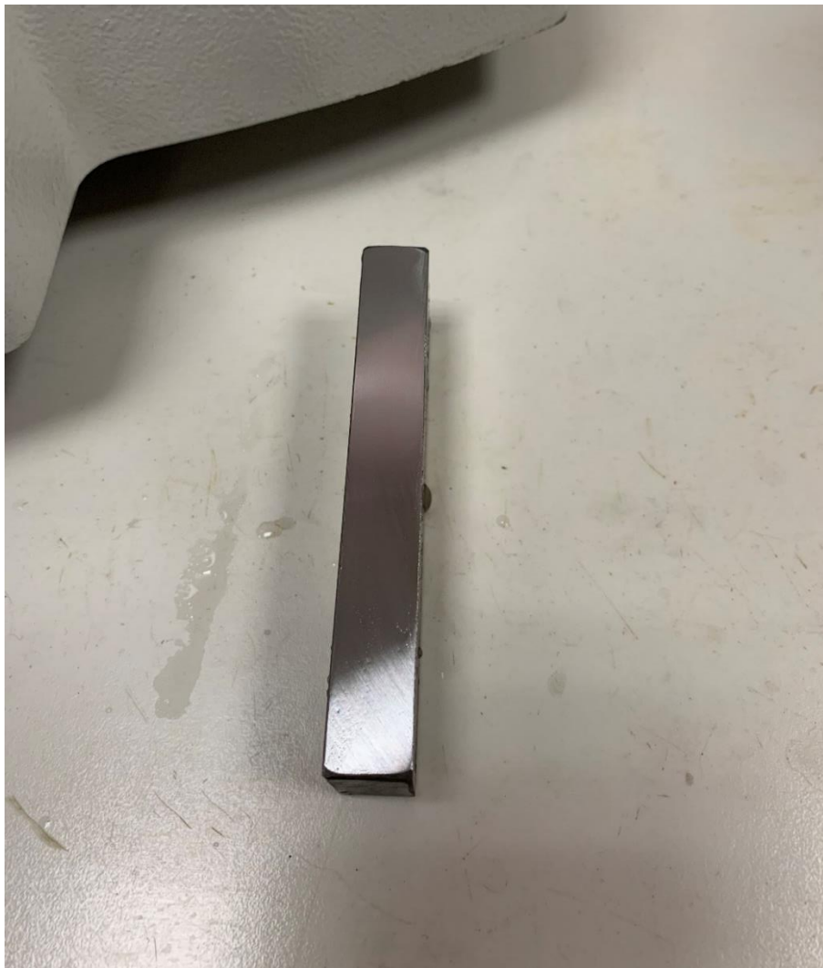
Рисунок 40 – Зеркальная поверхность сварного образца после шлифовки и полировки
