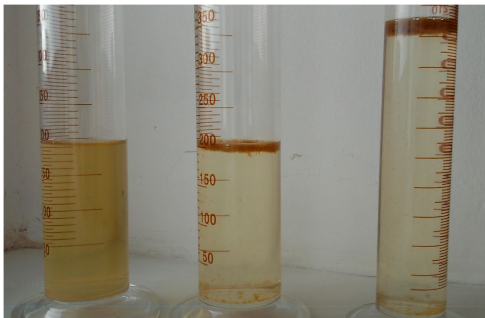
Рисунок 4.4 – Коагулирование сульфатом железа в дозах 10, 20, 30 мг/л по активному веществу (слева направо)
