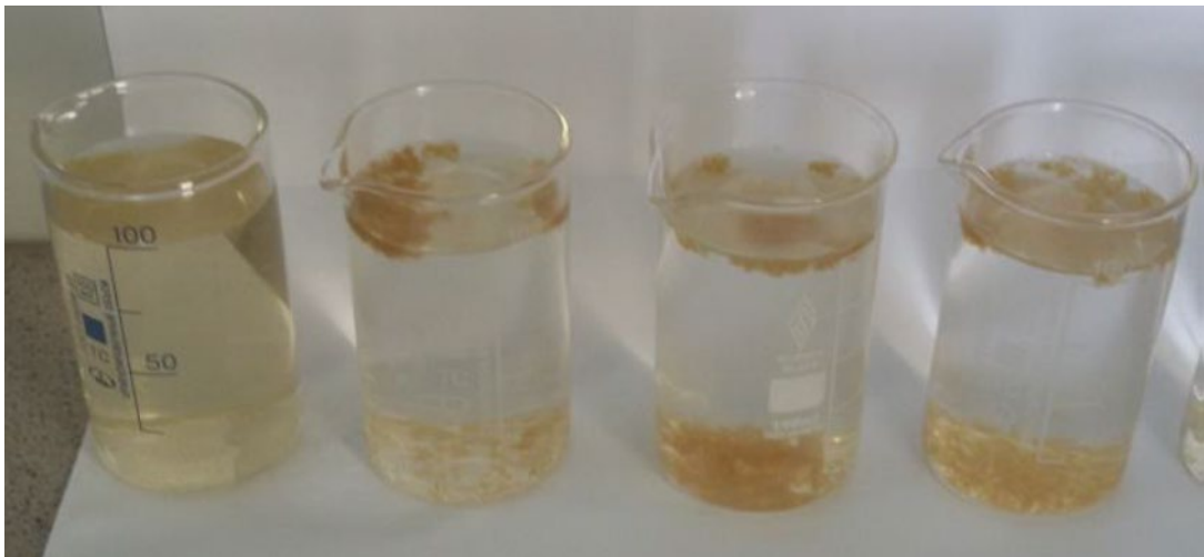
Рисунок 4.9 – Речная вода, полиоксихлорид алюминия в дозе 30 мг/л с неионогенным, катионным и анионным флокулянтом в дозировке 5 мг/л (слева направо)
