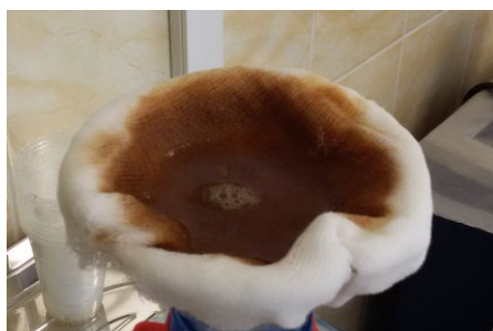
Рисунок 4.11 – Кольматация марлевого фильтра при фильтрации пробы
