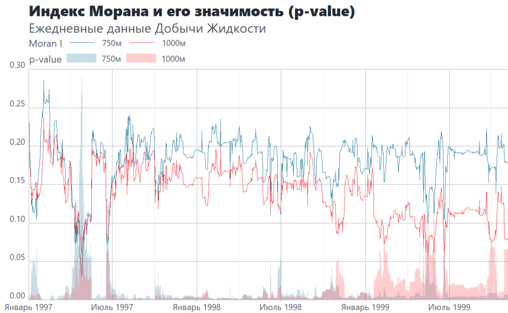
Рисунок 3.9 – Коэффициенты корреляции Морана и их статистическая значимость для ежедневного дебита жидкости добывающих скважин в радиусе 750 м, для добывающих скважин в радиусе 1000 м
