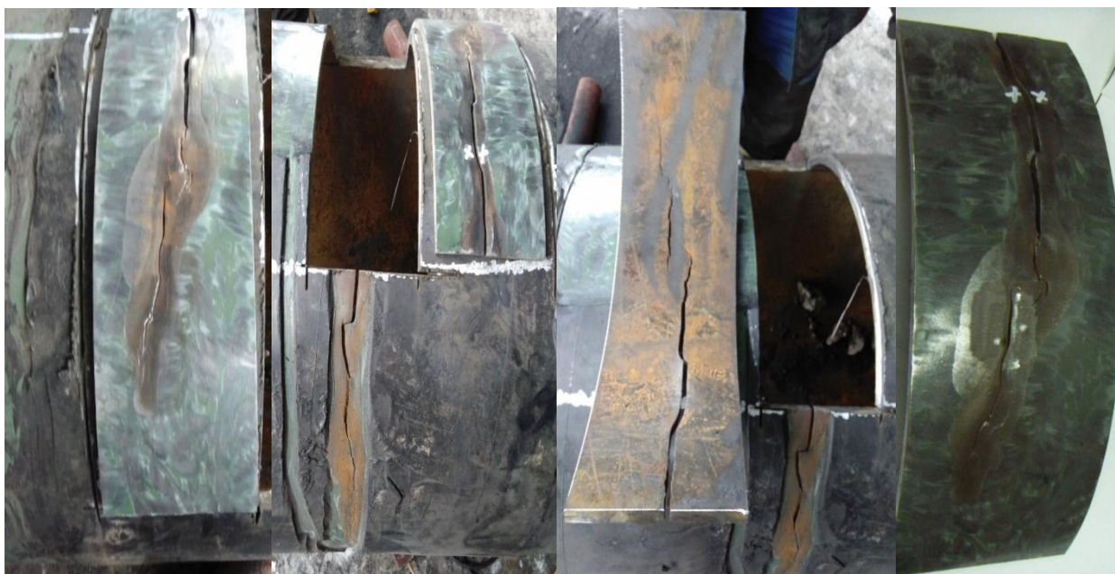
Рисунок 2.3 – Фрагменты разрушенного участка трубы
