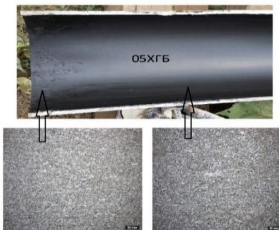
Рисунок 3.7 – Микроструктура участка катушки стали 05XГБ: а) в зоне с максимальными коррозионными поражениями (б) участка без коррозионных повреждений
