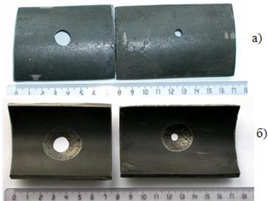
Рисунок 1.5 – Биоразрушение материала трубопровода: а) наружная б) внутренняя поверхность
