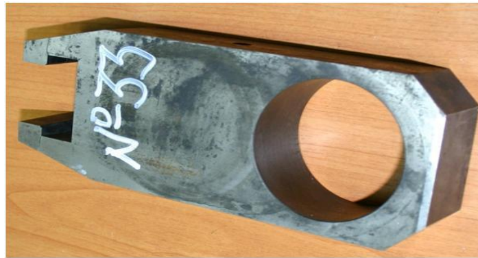
Рисунок 2.23 – Шибер задвижки ЗМС–65x21 К2, №33
