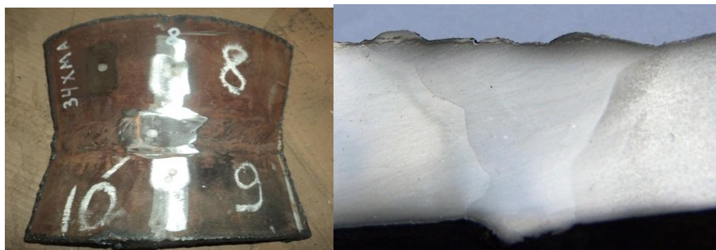
Рисунок 2.1 – Переход с дефектным сварным швом:
