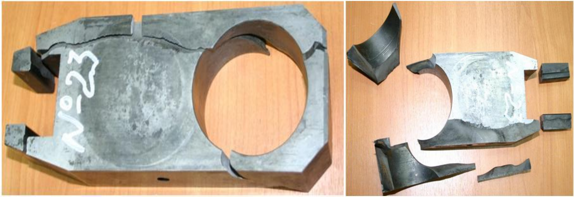
Рисунок 2.22 – Шибер задвижки ЗМС – 65x21 К2, №23
