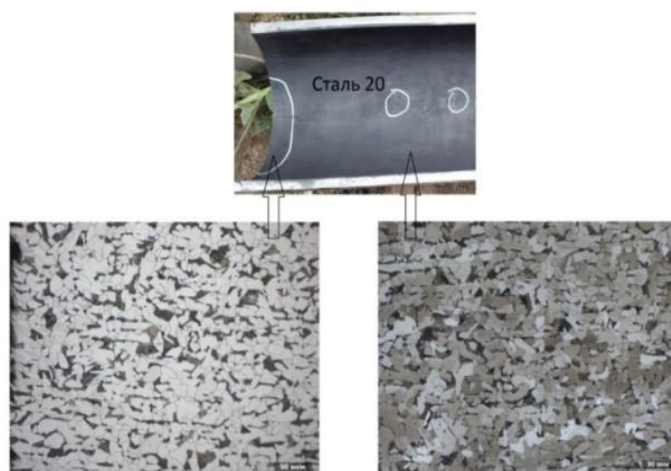
Рисунок 3.7 – Микроструктура участка катушки стали 05XГБ: а) в зоне с максимальными коррозионными поражениями (б) участка без коррозионных повреждений
