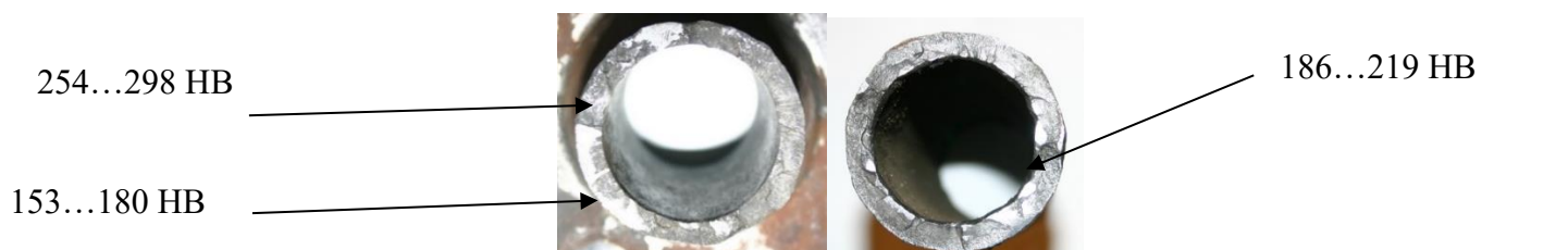
Рисунок 2.38 – Твердость металла сварного шва
