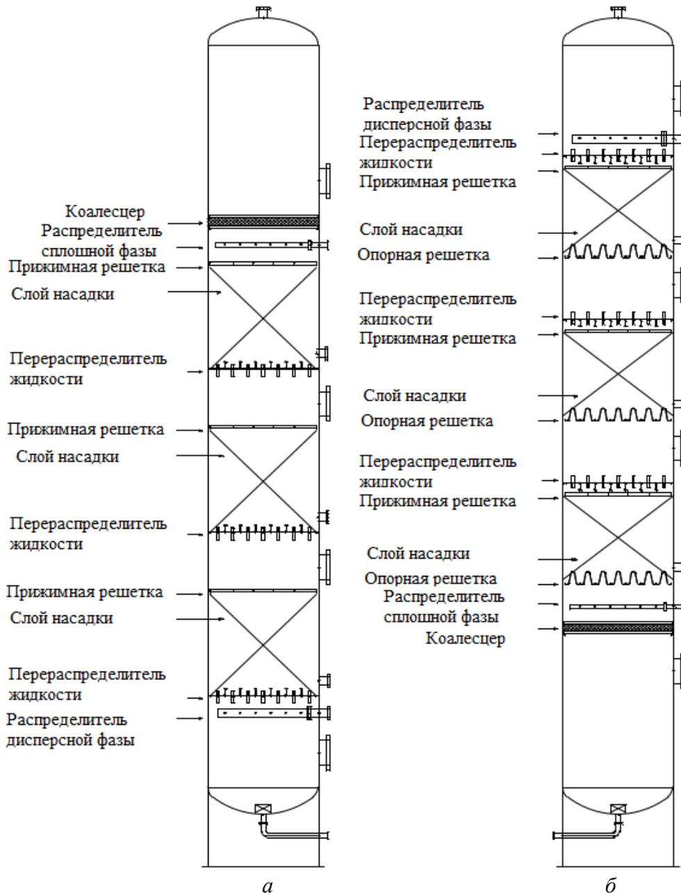
*а* – экстрактор с диспергированием легкой фазы, *б* – экстрактор с диспергированием тяжелой фазы
