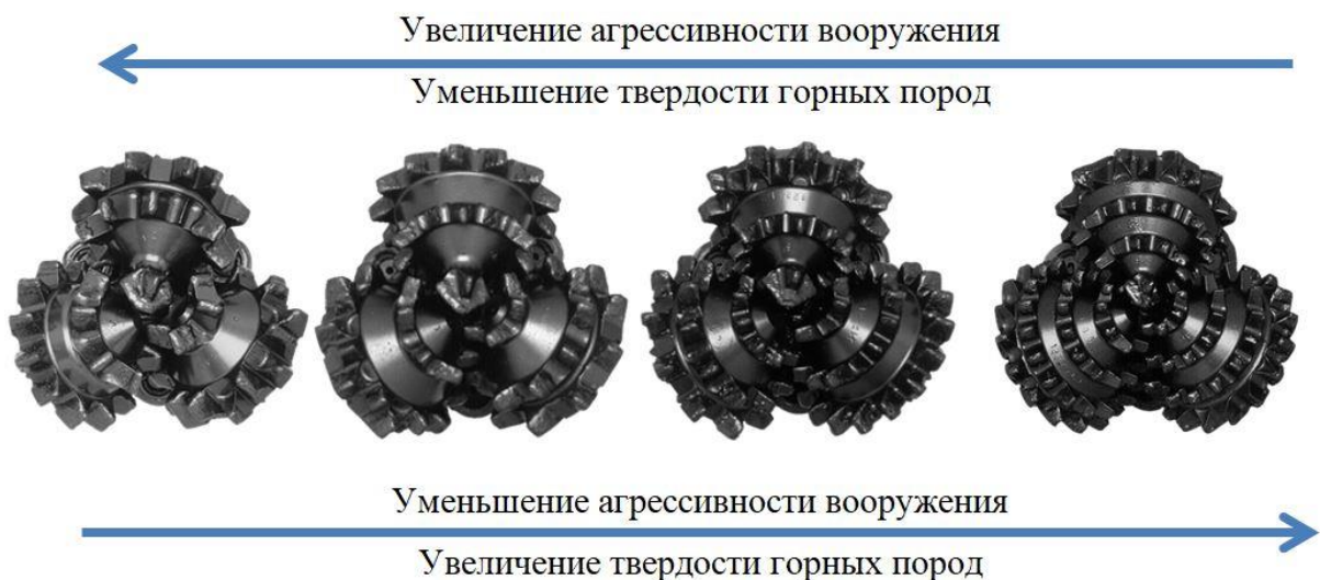
Рисунок 1.6 – Общий вид вооружения шарошечных долот
