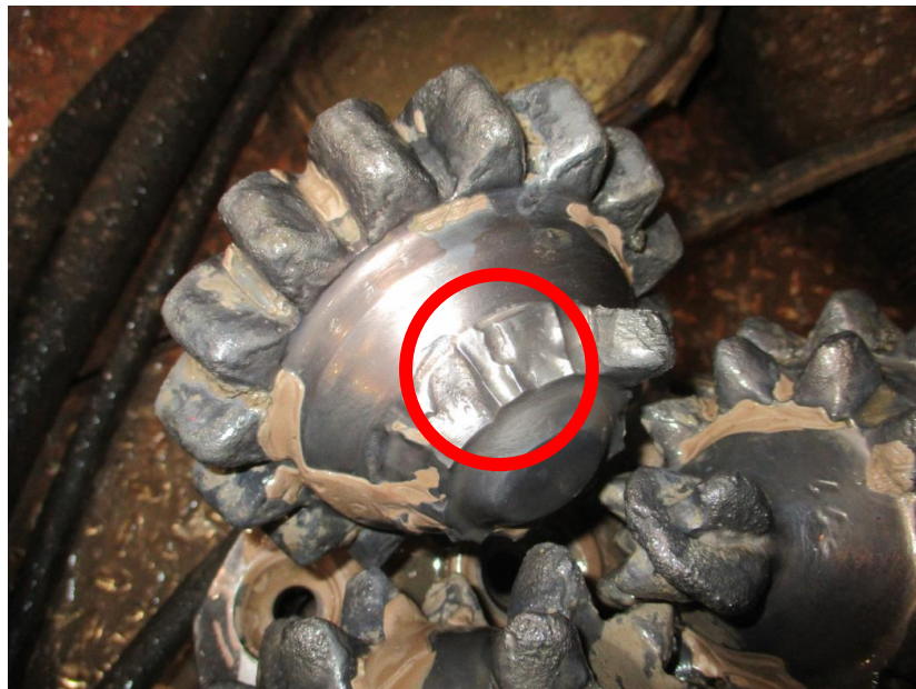
Рисунок 2.6 – Шарошка со сломанными зубьями ряда 2
