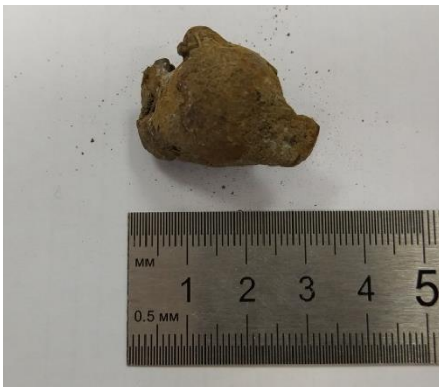
Рисунок 2.2 – Образец шлама – галечник с размерами до 30 мм
