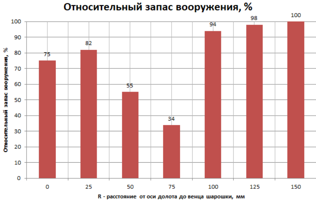
Рисунок 2.7 – Относительный запас вооружения БИТ 295,3 Z1RSJ U643 (IADC 117)
