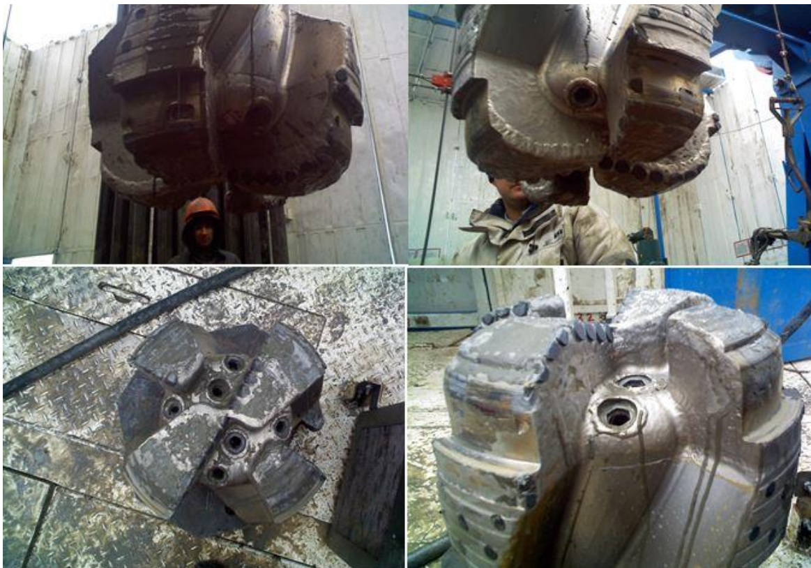
Рисунок 1.14 – Долото БИТ 393,7 В419 со следами катастрофического износа
