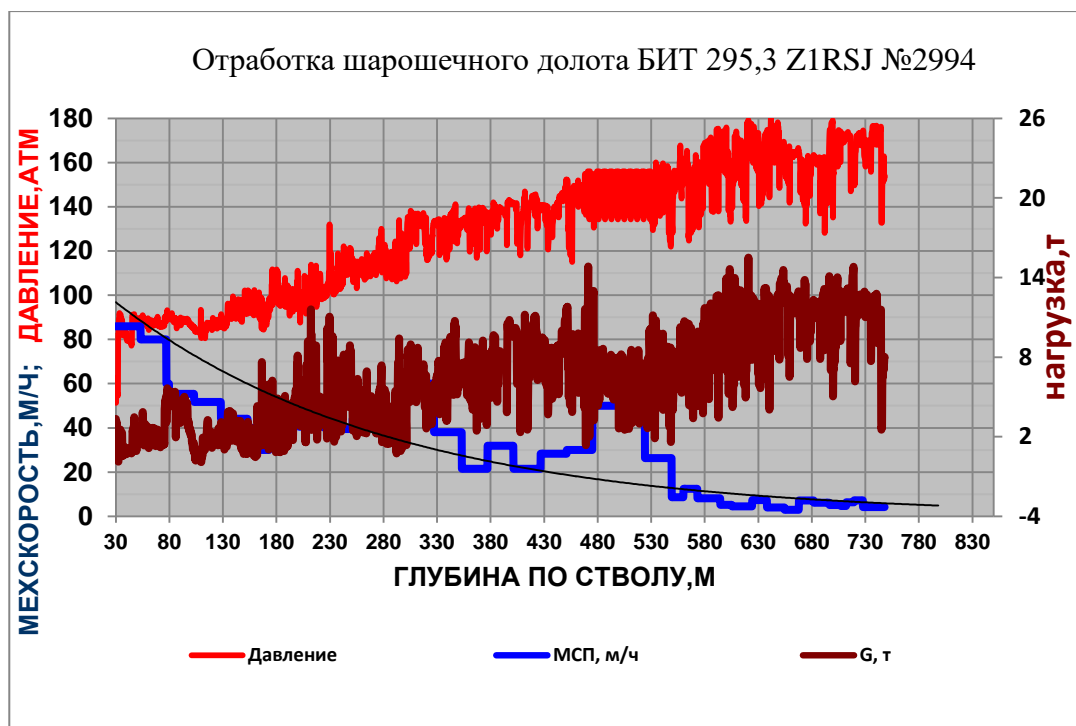
Рисунок 2.12 – Хронология отработки долота БИТ 295,3 Z1RSJ №2994
