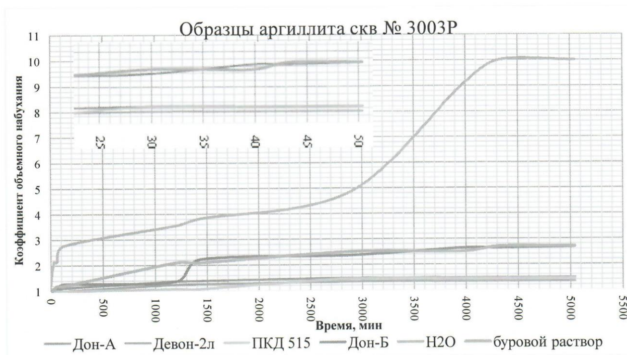
Рисунок 1 – Кинетика набухания образцов аргиллита скв № 3003Р в воде, а также в различных средах в течение 72 часов
