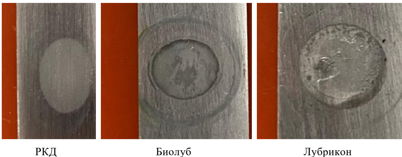
Рисунок 3.7 - Коррозионные поражения СтЗ в модели пластовой воды (АОИК), с добавлением реагентов
