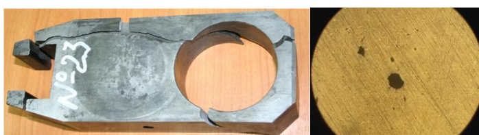
Рисунок 3 – Шибер задвижки ЗМС-65x21 К2 ×200
