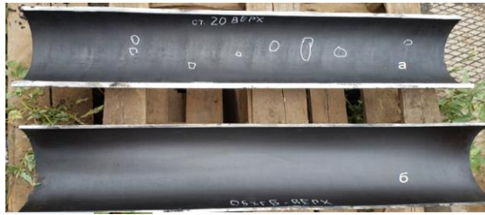
Рисунок 6 – Верхние сегменты катушек стали 20 (а) и стали 05ХГБ (б) байпасного стенда
