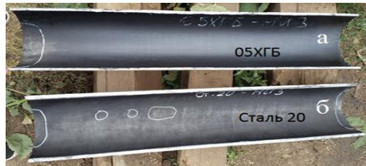
Рисунок 7 – Нижние сегменты катушек стали 05ХГБ (а) стали 20 (б) байпасного стенда
