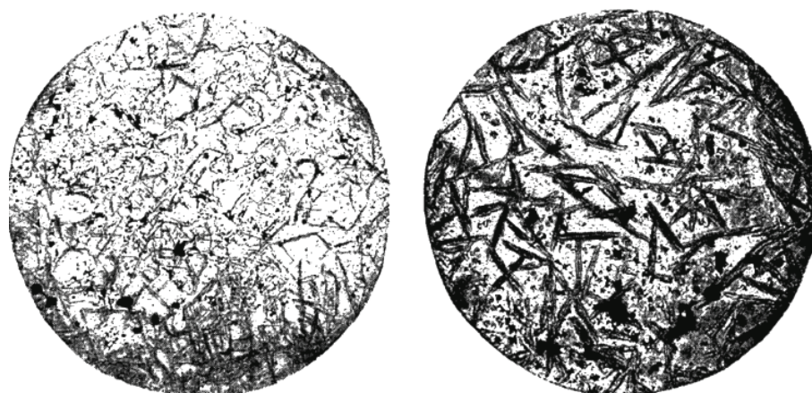
Рисунок 12 – Микроструктура кристаллов n -тетраэтоктана из 2%-го раствора в n -гептане без присадки и в ее присутствии (0,5%)
