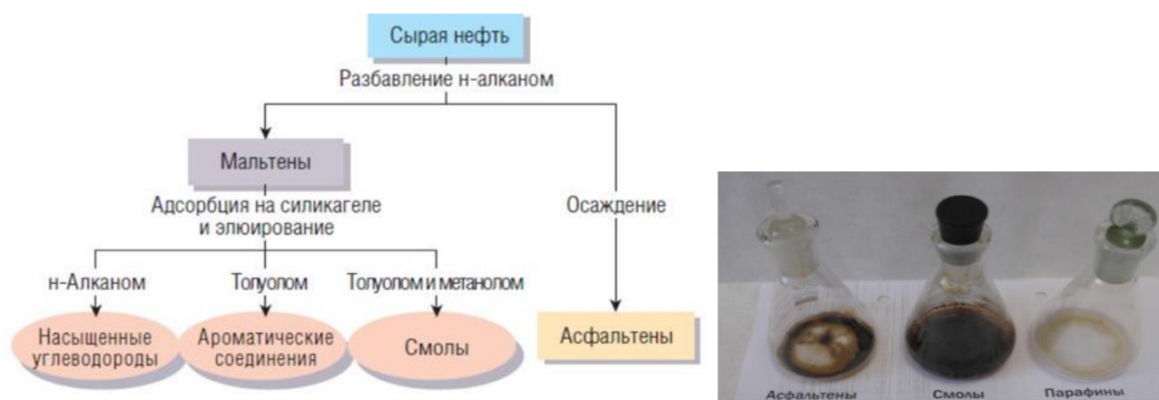
Рисунок 3.2 – Современная методика выделения высокомолекулярных соединений в нефти [77]
