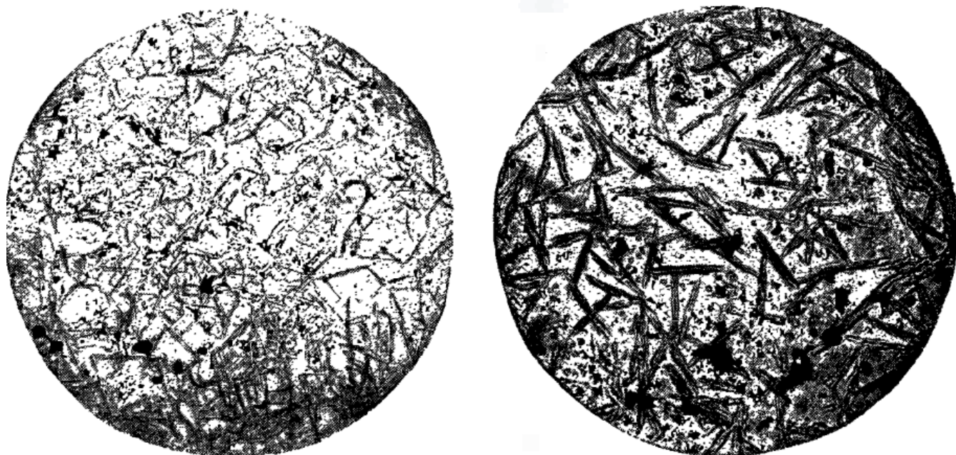
Рисунок 3.14 – Микроструктура кристаллов н-тетратриокоитана из 2%ного раствора в н-гептане без присадки парафлуо и в его присутствии с 0,5% содержанием [191]
