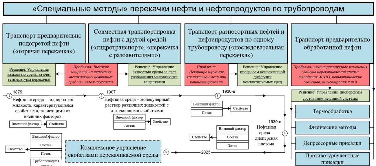
Рисунок 4.3 – Развитие знаний о внутренней структуре и строении нефтяных сред и их влияние на становление новых технологий их трубопроводного транспорта
