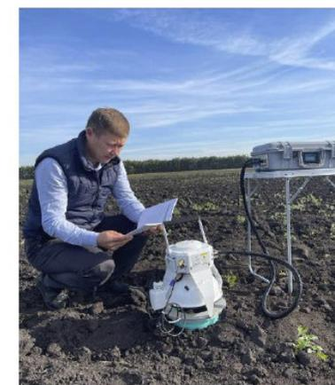
**Исследование почвенного дыхания на пашне в осенний период с использованием Li-Cor 7810**
