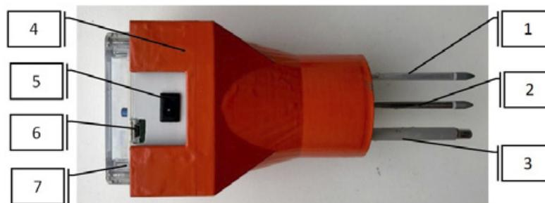
«1 – щуп рН грунта; 2 – щуп температуры; 3 – щуп влажности грунта; 4 – корпус индикатора контроля параметров грунта; 5 – кнопка «Включение – Выключение» блока контроля параметров грунта; 6 – кнопка «Включение – Выключение» блока позиционирования (GPS, Глонасс); 7 – крышка индикатора.»
