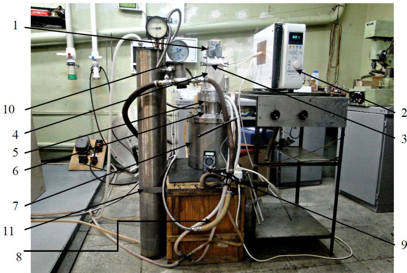
Рисунок 25 - Фотография установки для исследования пиролиза торфа с использованием сверхразмерного СВЧ - реактора: 1 - промышленный 2.45 ГГц / 1 кВт магнетрон; 2 - система высоковольтного питания; 3 - система воздушного охлаждения магнетрона; 4 - согласующие волноводные элементы; 5 - барьерное окно; 6 - волновод связи; 7 - рабочая камера реактора; 8 - система водяного охлаждения реактора; 9 - термопара; 10 - манометр; 11 - теплообменник для охлаждения выходных газов из реактора.
