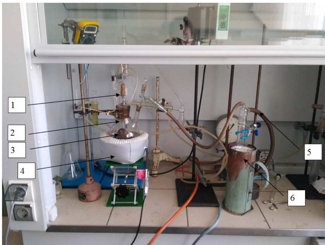
Рисунок 14 - Фотография экспериментальной установки пиролиза торфа с электронагревательным элементом: 1 - термопара, 2 - реакционный сосуд (кварцевая колба Вюрца), 3 - навеска с торфом, 4 - электронагревательный элемент, 5 - откачной порт форвакуумного насоса, 6 - азотная ловушка
