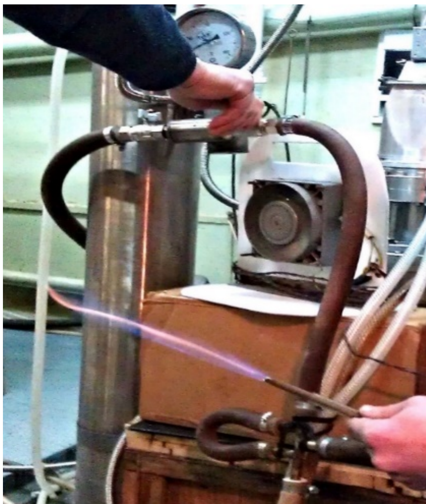
Рисунок 28 - Демонстрация горения газов, выделившихся в реакторе в процессе пиролиза торфа
