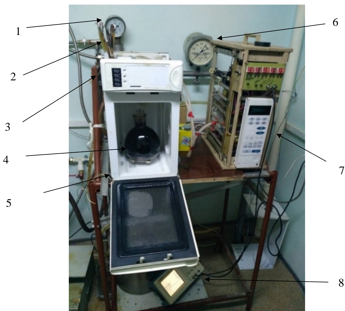
Рисунок 16 - Внешний вид установки СВЧ - пиролиза на основе кварцевого реакционного сосуда: 1 - газовый счетчик, 2 - система водяного охлаждения магнетрона, 3 - магнетрон, 4 - реакционный сосуд (колба Вюрца), 5 - изолирующая камера, 6 - манометр, 7 - высоковольтный источник питания магнетрона, 8 - осциллограф
