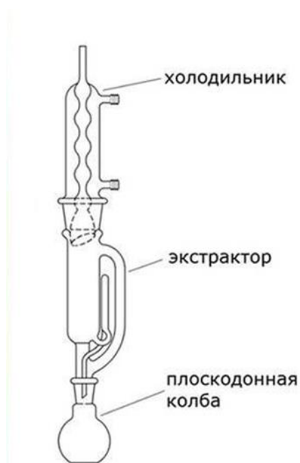
Рисунок 17– Аппарат Сокслета для экстрагирования
