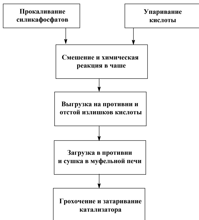
Рисунок 5 – Принципиальная схема производства катализатора ПФК/СФ-2
