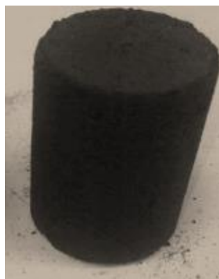
Рисунок 2.1 – Искусственный образец из кернового материала баженовской свиты Приобского месторождения
