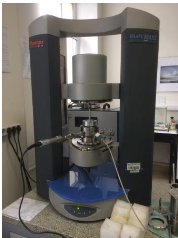
Рисунок 2.1 – Реометр и ячейка высокого давления для определения эффективности ингибирования образования газовых гидратов MARS (НААКЕ)
