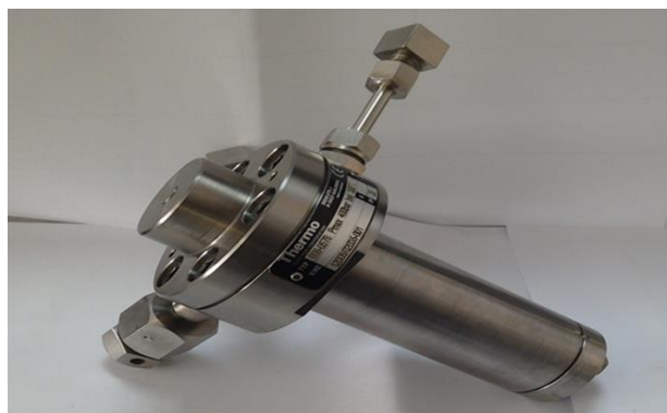
Рисунок 2.1 – Реометр и ячейка высокого давления для определения эффективности ингибирования образования газовых гидратов MARS (НААКЕ)
