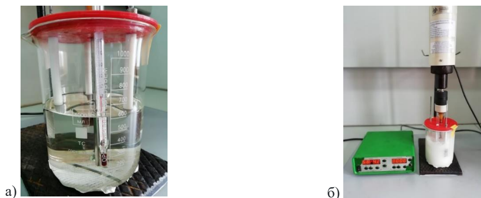
Рисунок 1 –Установка для проведения исследований влияния циклических перекачек на качество НП, где (а) – статические исследования, (б) – динамические
