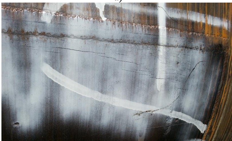
Рисунок 1 – Результаты ВТД участка МГ (а) и наружного вихретокового контроля трубы МГ №10040 (б)
