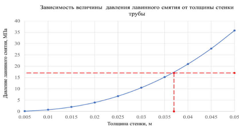
Рисунок 1 - Зависимость величины давления лавинного смятия от толщины стенки трубы.
