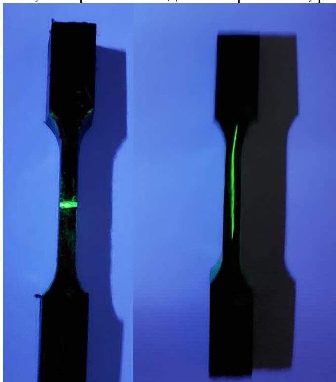
Рисунок 1 – Проявление продольных и поперечных дефектов люминофорами
