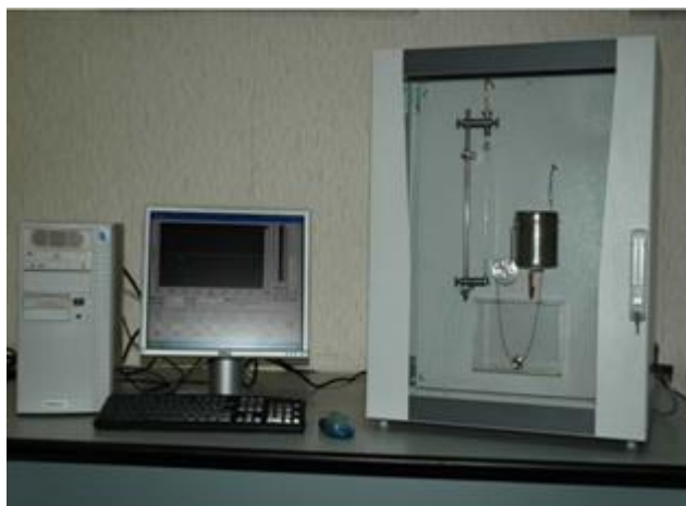
Рисунок 1 – Установка «Градиент-М» производства АО «ИНХП»
