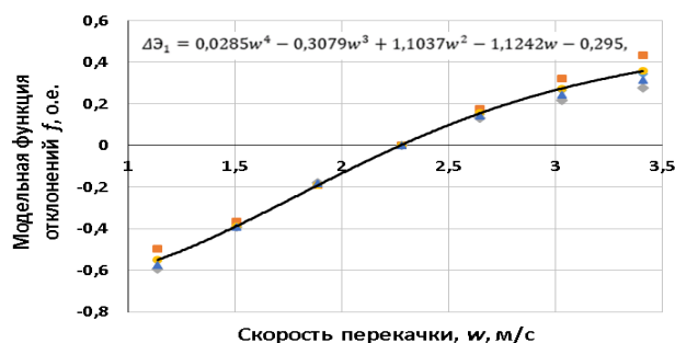
Рисунок 2 – Аналитическая зависимости отклонений преобразованного энергетического эффекта от скорости перекачки
