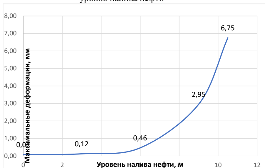
Рисунок 2 – График зависимости максимальных деформаций РВС-5000 от уровня налива нефти
