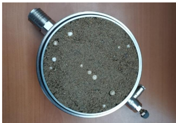
Рисунок 1 - Смесь «Песчаный грунт – гранулы вспененного полистирола (5%)»
