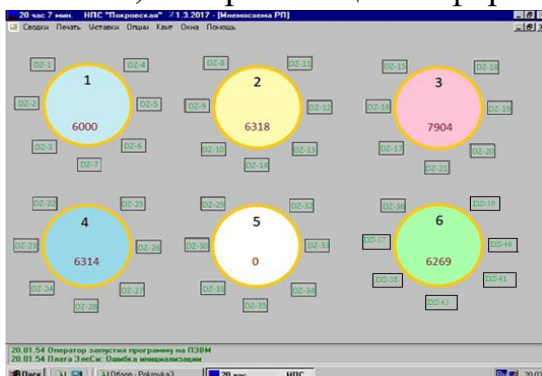
Рисунок 1 - Схема сигнализаторов ГВС
