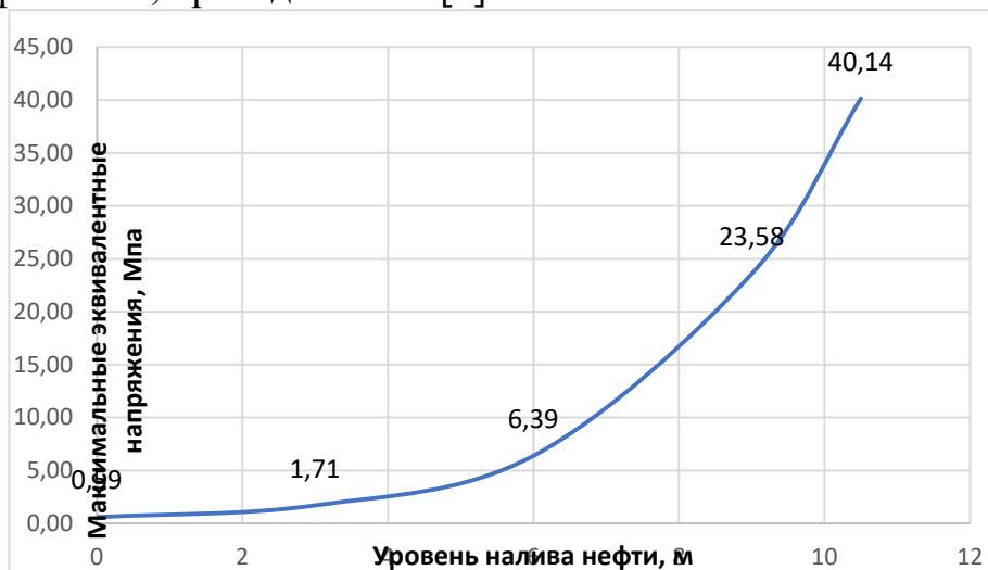
Рисунок 1 – График зависимости максимальных эквивалентных напряжений РВС-5000 от уровня налива нефти
