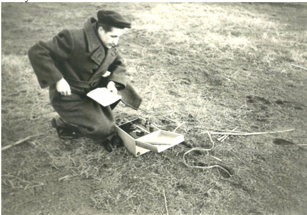
Аспирант П.И.Тугунов с помощью переносного потенциометра проводит измерение температурного поля грунта вокруг нефтепровода Озек-Суат-Грозный (1959)
