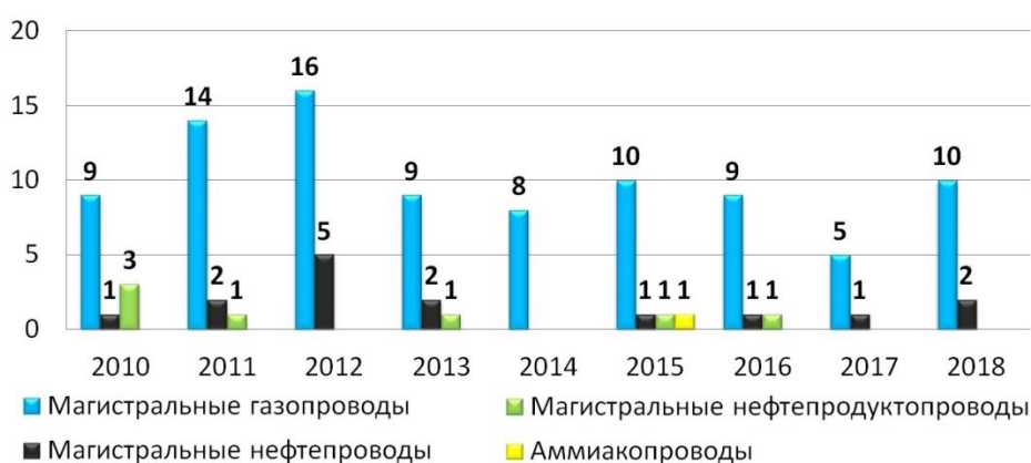
Рисунок 2 – Распределение аварийности на магистральных трубопроводах в зависимости от их назначения
