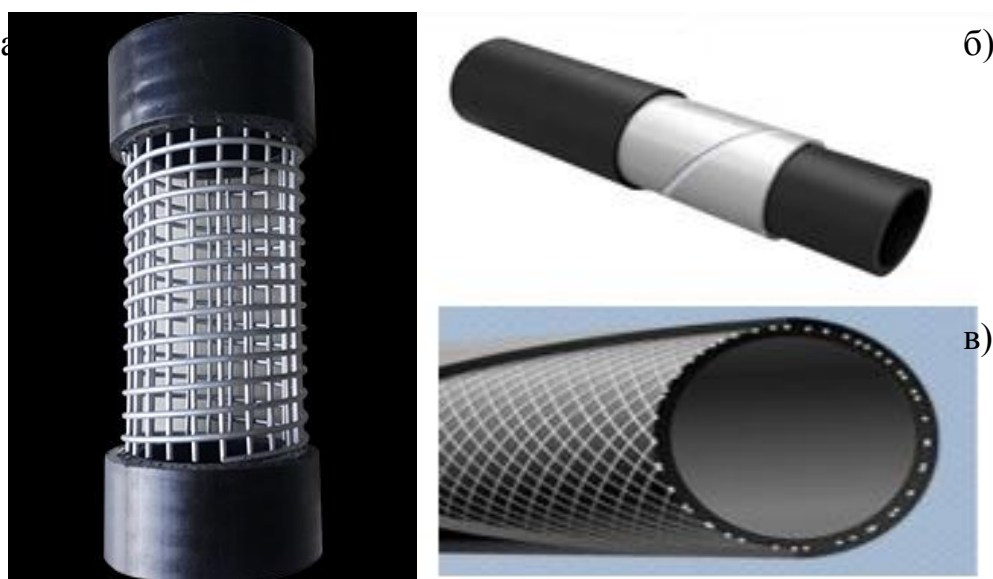
а) жесткая ПАТ с армирующим сетчатым каркасом; б) гибкая ПАТ с несвязанными слоями армированная лентами; в) гибкая ПАТ со связанными слоями армированная синтетическими нитями
