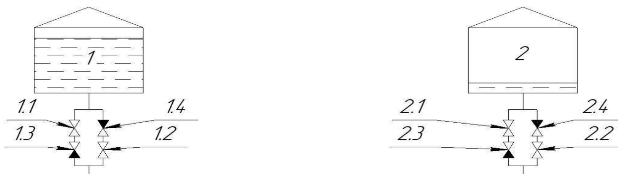
Рисунок 2 – Принципиальная схема обвязки резервуаров предотвращающая переток при переключении резервуаров
