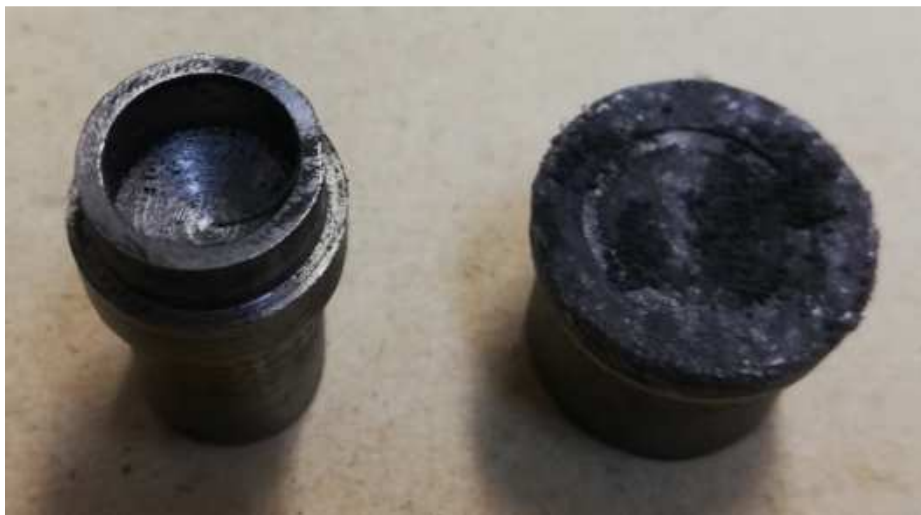
Рисунок 1 – Результаты испытаний на фреттинг пары трения Сталь 20 – паронит
