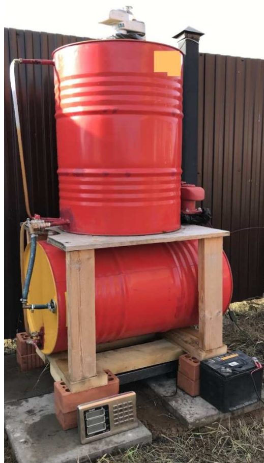
Рисунок 2 – Модель резервуара с атмосферной камерой
