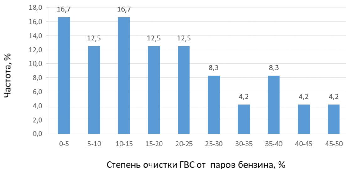
Рисунок 1 – Гистограмма степени очистки ГВС от паров бензина
