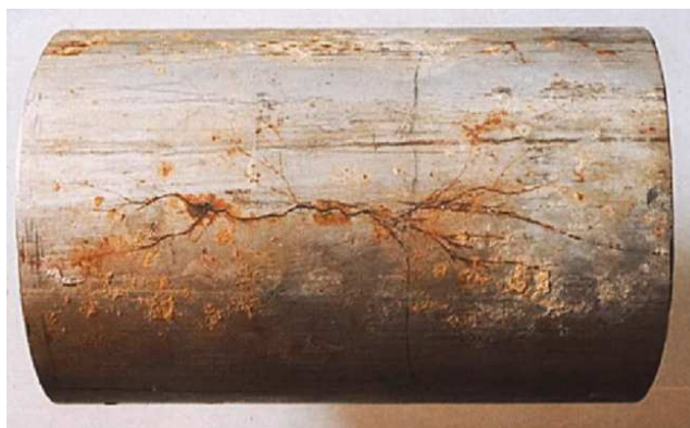
Рисунок 1- КРН на трубопроводе
