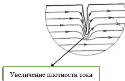
Рисунок 2 - Увеличение плотности тока на вершине трещины
