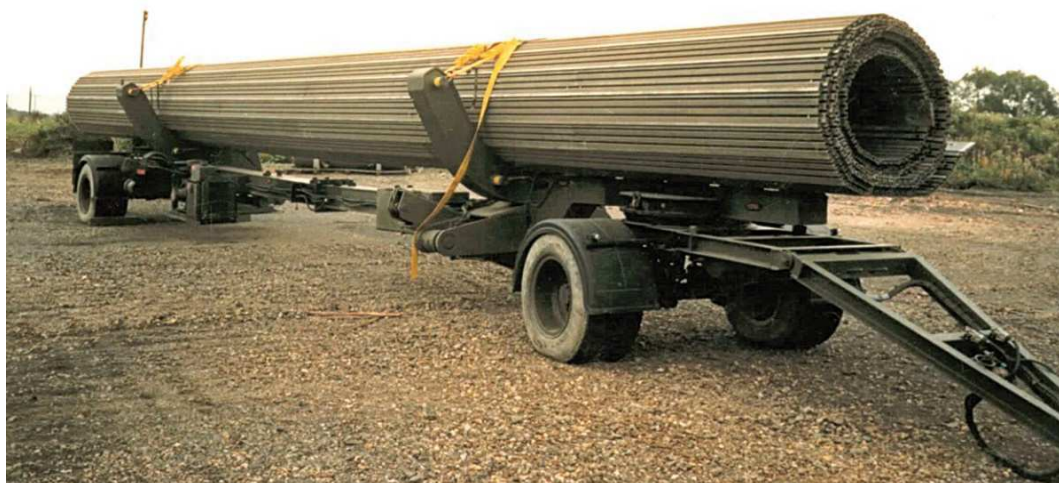
Рисунок 2 – Свернутое в рулон дорожное полотно FAUN Trackway
