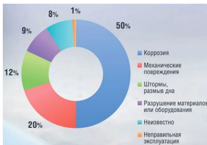
Рисунок 1 – Среднестатистическая частота аварий на морских подводных трубопроводах
