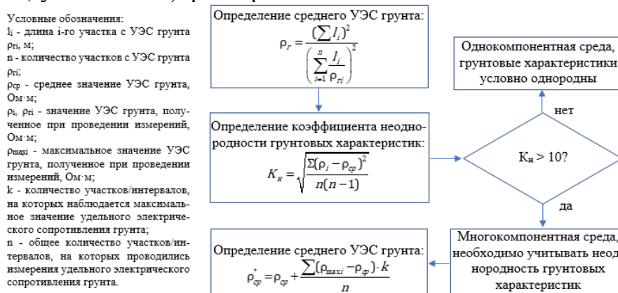
Рисунок 2 – Порядок расчета коэффициента неоднородности грунтов
