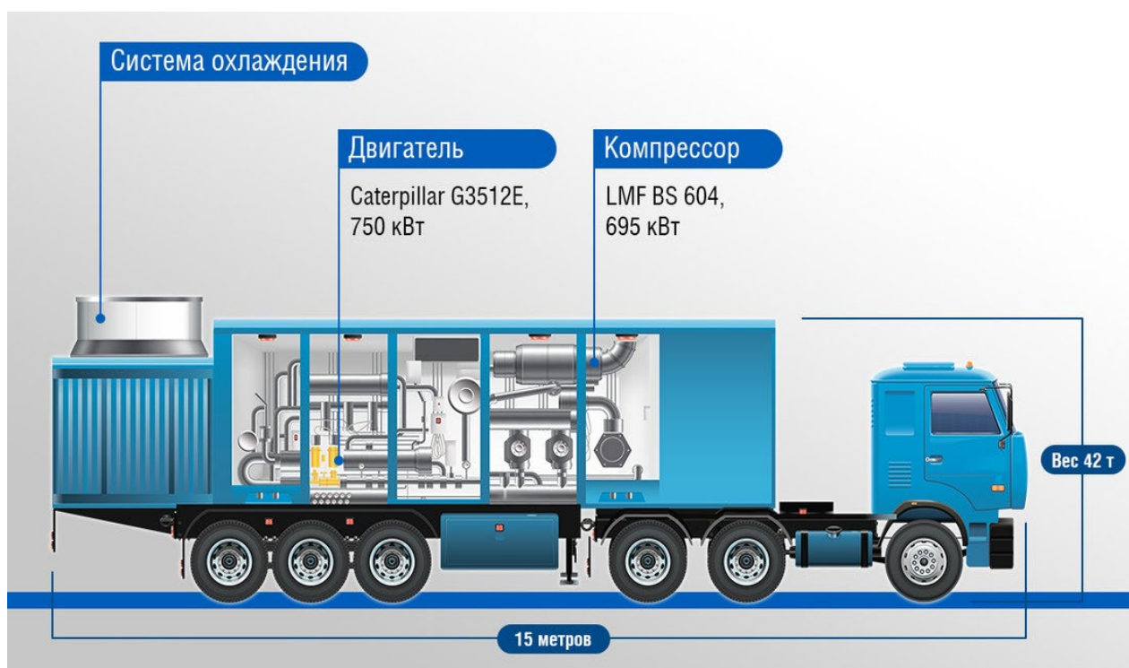
Рисунок 1 – Мобильная компрессорная установка
