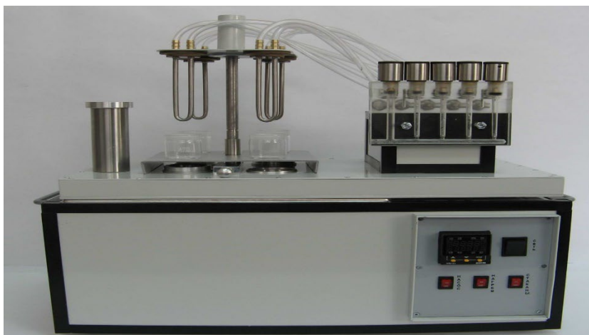
Рисунок 1 – Установка «холодный стержень»
