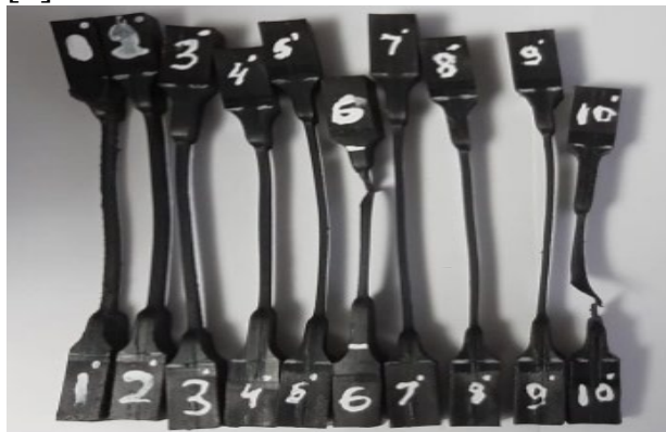
Рисунок 2,3 - Результаты испытаний образцов без температурного и УФ взаимодействиями и с температурным и УФ взаимодействиями
