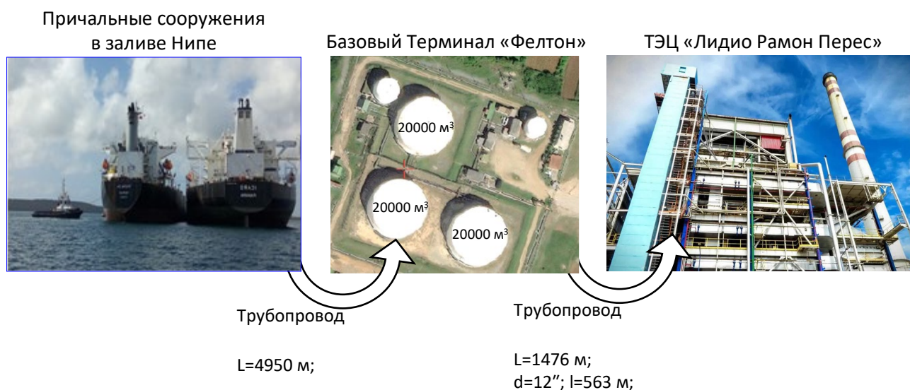
Рисунок 1 – Схема доставки топлива от терминала до ТЭЦ «Лидио Рамон Перес» (Куба)
