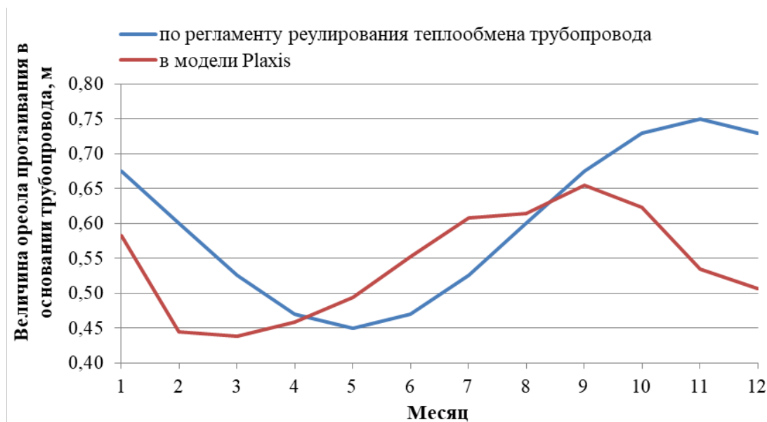
Рисунок 2 – Сравнение величин ореолов протаивания, рассчитанных по регламенту регулирования теплообмена трубопровода и в программном комплексе Plaxis
