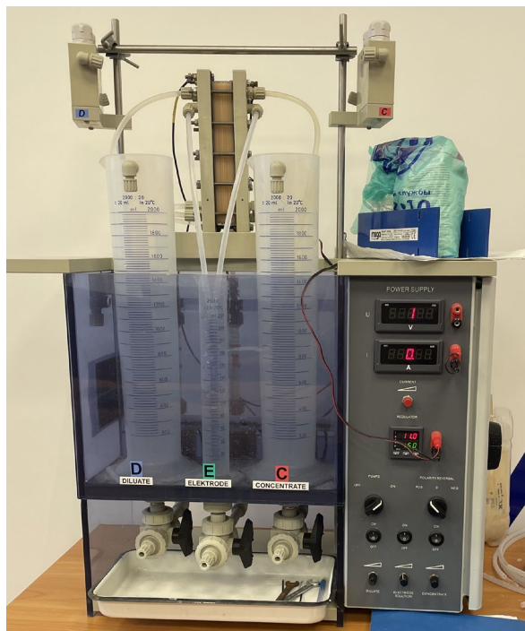
Рисунок 1 – Лабораторная установка электродиализа
