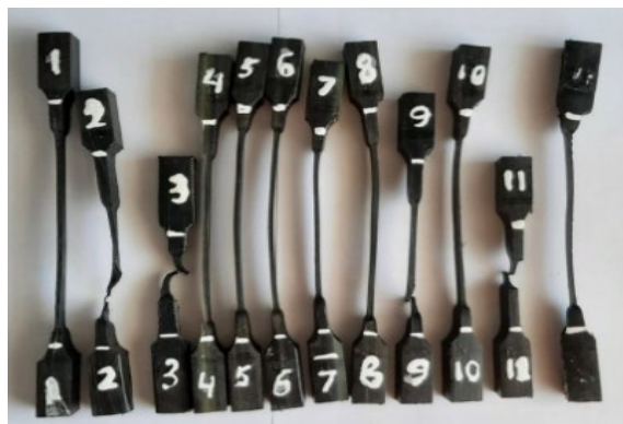
Рисунок 2,3 - Результаты испытаний образцов без температурного и УФ взаимодействиями и с температурным и УФ взаимодействиями
