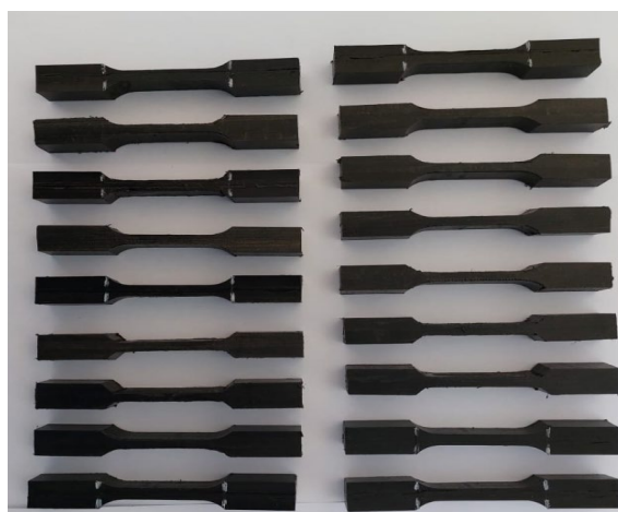
Рисунок 1 - Образцы для испытаний на одноосное растяжение
