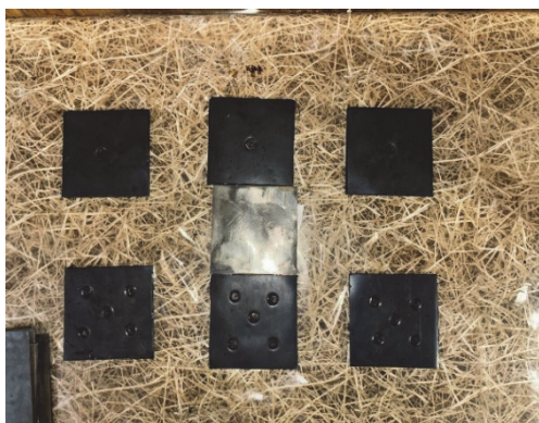
Рисунок 1. Результаты самовосстановления покрытия за 15 суток
