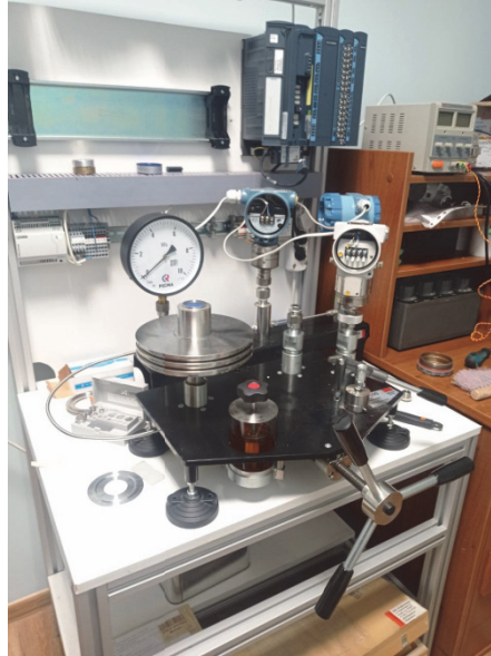
Рисунок 1. Гидравлический стенд для анализа работы датчиков давления
