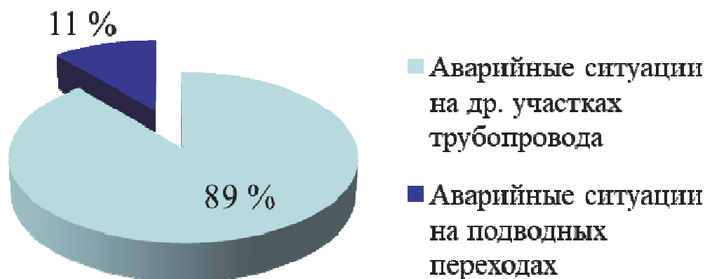
Рисунок 1. Диаграмма аварийных ситуаций на трубопроводах
