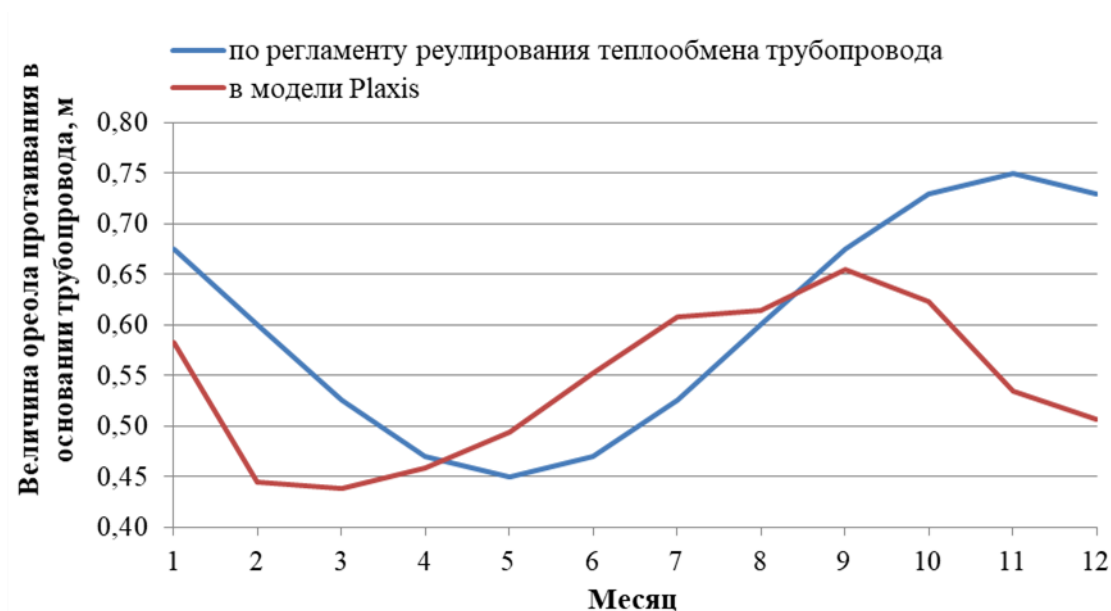
Рисунок 4 – Сравнение величин ореолов протаивания, рассчитанных по регламенту регулирования теплообмена трубопровода и в программном комплексе Plaxis
