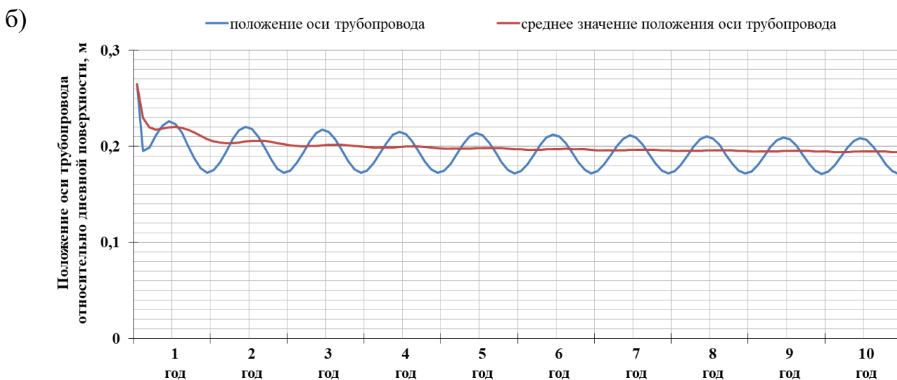
Рисунок 3.7 – а) Подбор параметра \alpha при R'_0=0,8 м, R''_0=0,2 м с целью минимизации колебаний температуры нефти в наземном трубопроводе в течение годового периода эксплуатации с учетом самопогружения трубопровода; б) Изменение высотного положения оси наземного трубопровода относительно дневной поверхности при самопогружении и параметрами теплообмена \alpha=270^\circ , R'_0=0,8 м, R''_0=0,2 м.
