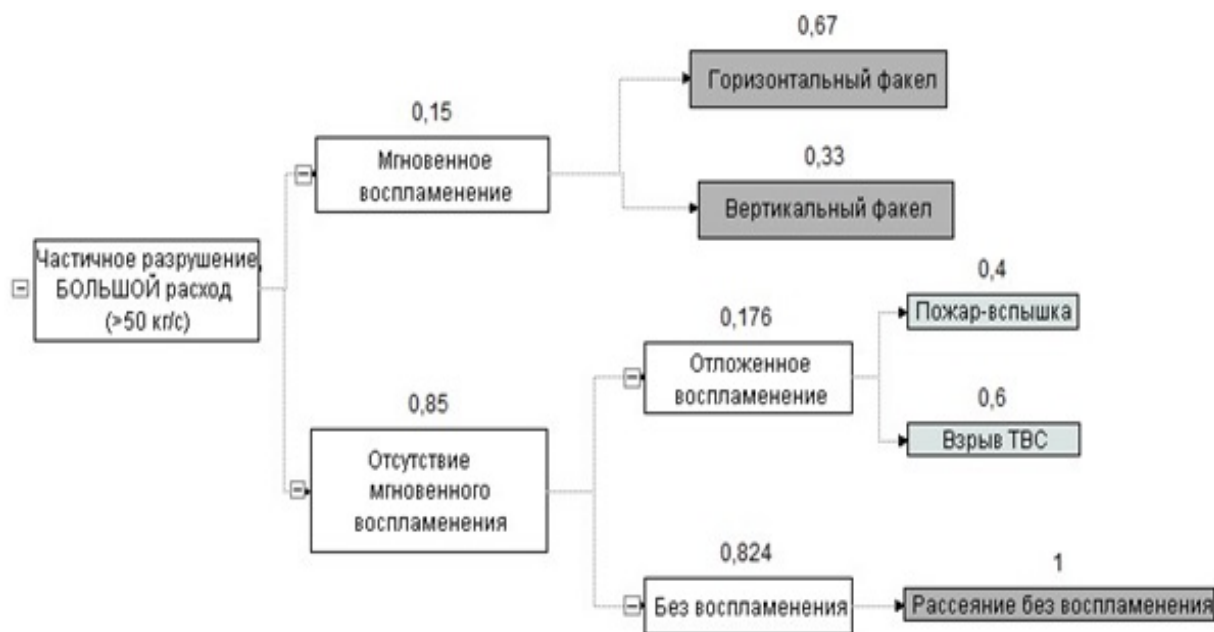
Рисунок 4.2 – «Дерево событий» пожароопасных ситуаций на нефтепроводе при большом расходе (более 50 кг/с)
