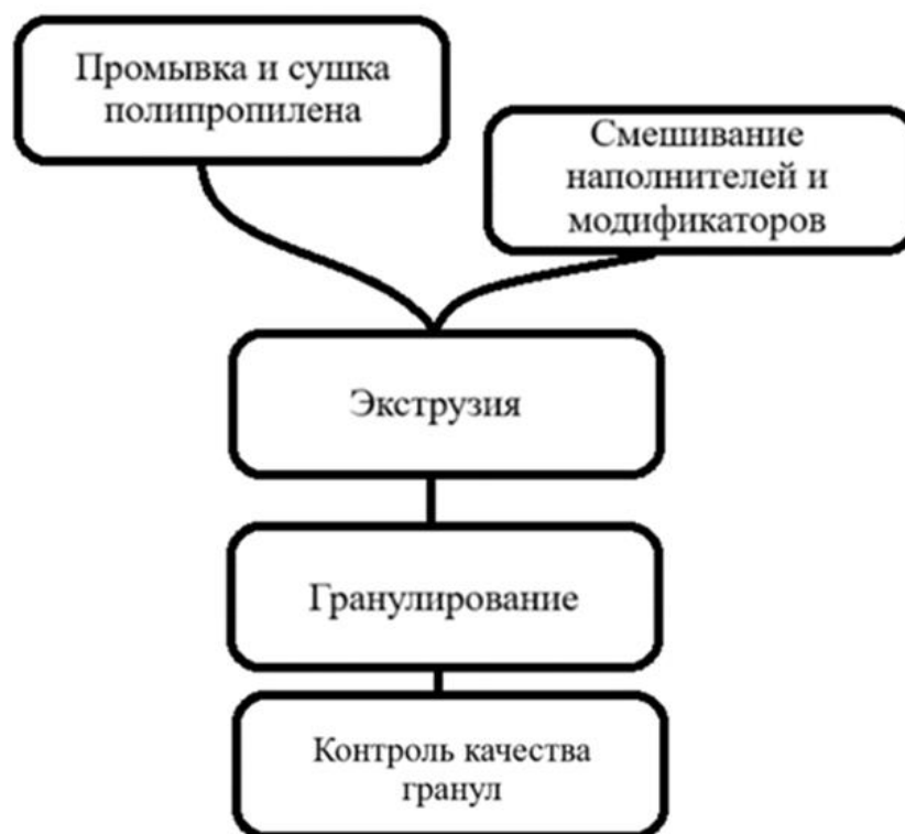
Рисунок 3.32 – Технологический процесс переработки полимерных композитов с получением пластмассовых изделий
