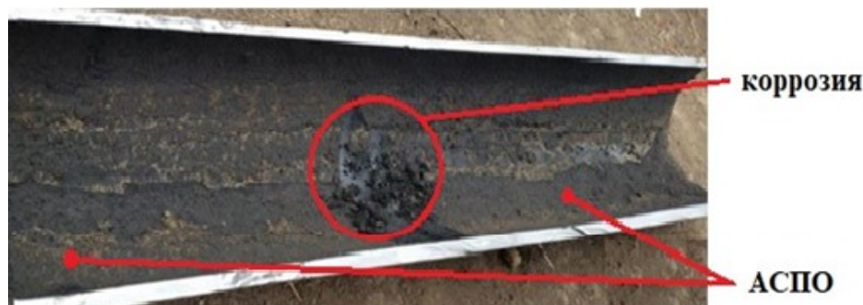
Рисунок 2 – Отложения АСПО на внутренней стенке диагностируемого нефтепровода
