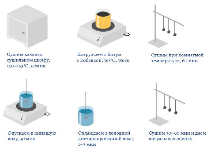
Рисунок 2.3 – Схема испытаний сцепления битумного вяжущего с поверхностью щебня [163]
