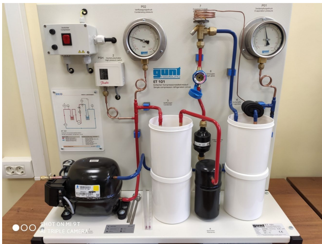
Рисунок 4.8 – Лабораторный стенд «Модель парокомпрессионной холодильной машины ET-101»
