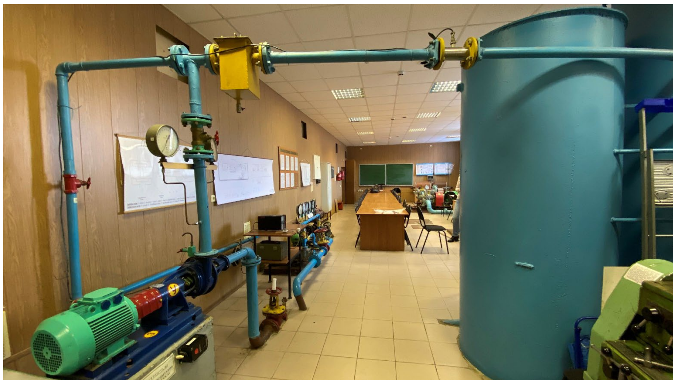
Рисунок 3.19 – Лабораторная установка «Кавитационные испытания центробежного насоса»
