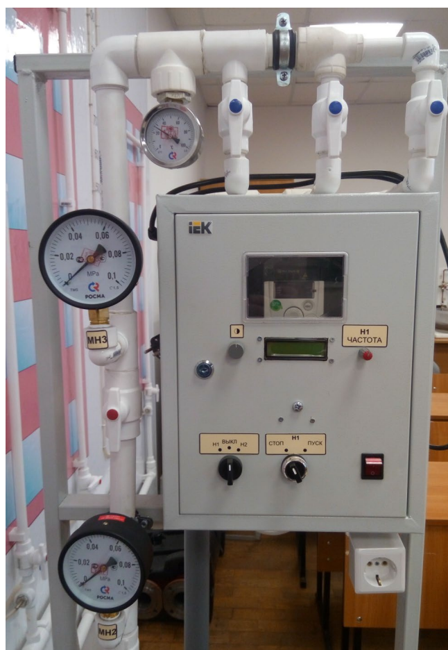
Рисунок 4.18 – Энергоэффективное регулирование работы центробежных насосов
