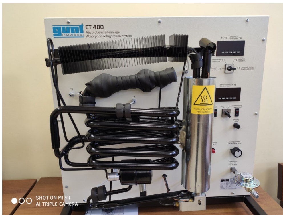
Рисунок 4.9 – Лабораторный стенд «Модель абсорбционной холодильной установки ET-480»
