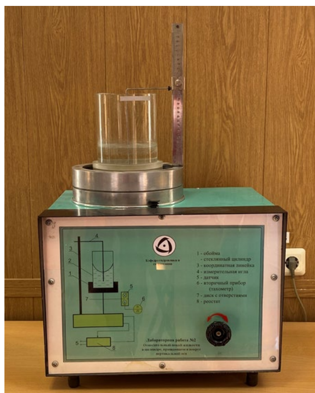
Рисунок 3.11 – Лабораторная установка «Относительный покой жидкости в цилиндре, вращающемся вокруг вертикальной оси»
