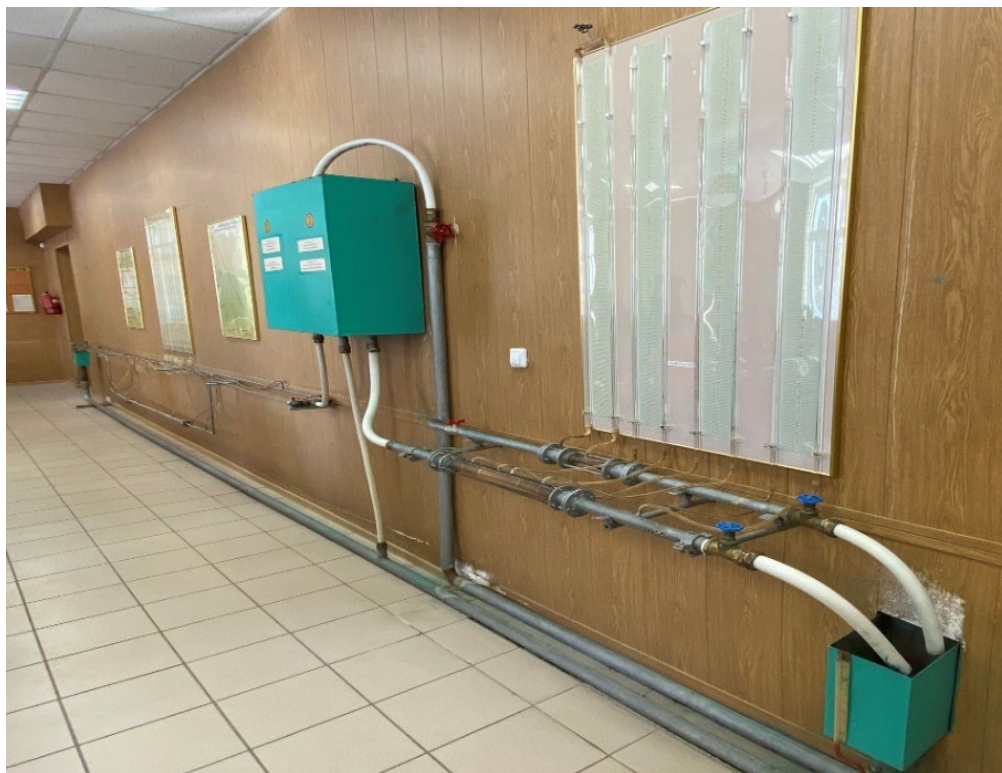
Рисунок 3.14 – Лабораторная установка «Построение линий энергии и потенциальной энергии»; «Водомер Вентури»; «Определение коэффициентов местных сопротивлений»; «Определение коэффициента Дарси при течении жидкости в прямой круглой трубе»
