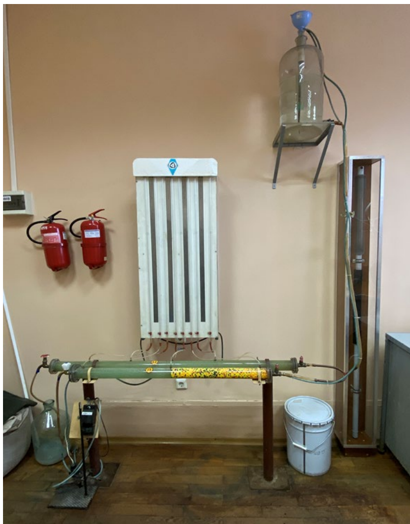
Рисунок 3.24 – Экспериментальная установка для изучения одномерной установившейся фильтрации жидкости в пористой среде
