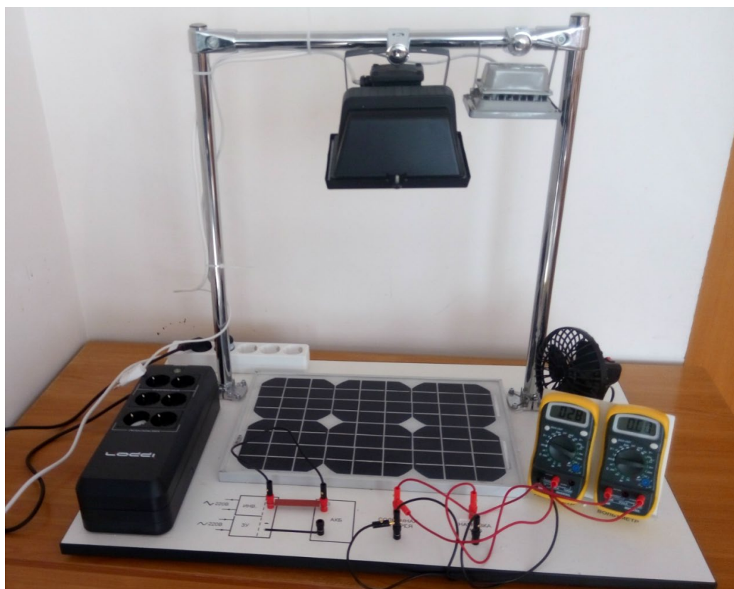
Рисунок 4.14 – Лабораторно-исследовательский стенд для изучения фотоэлектрической системы
