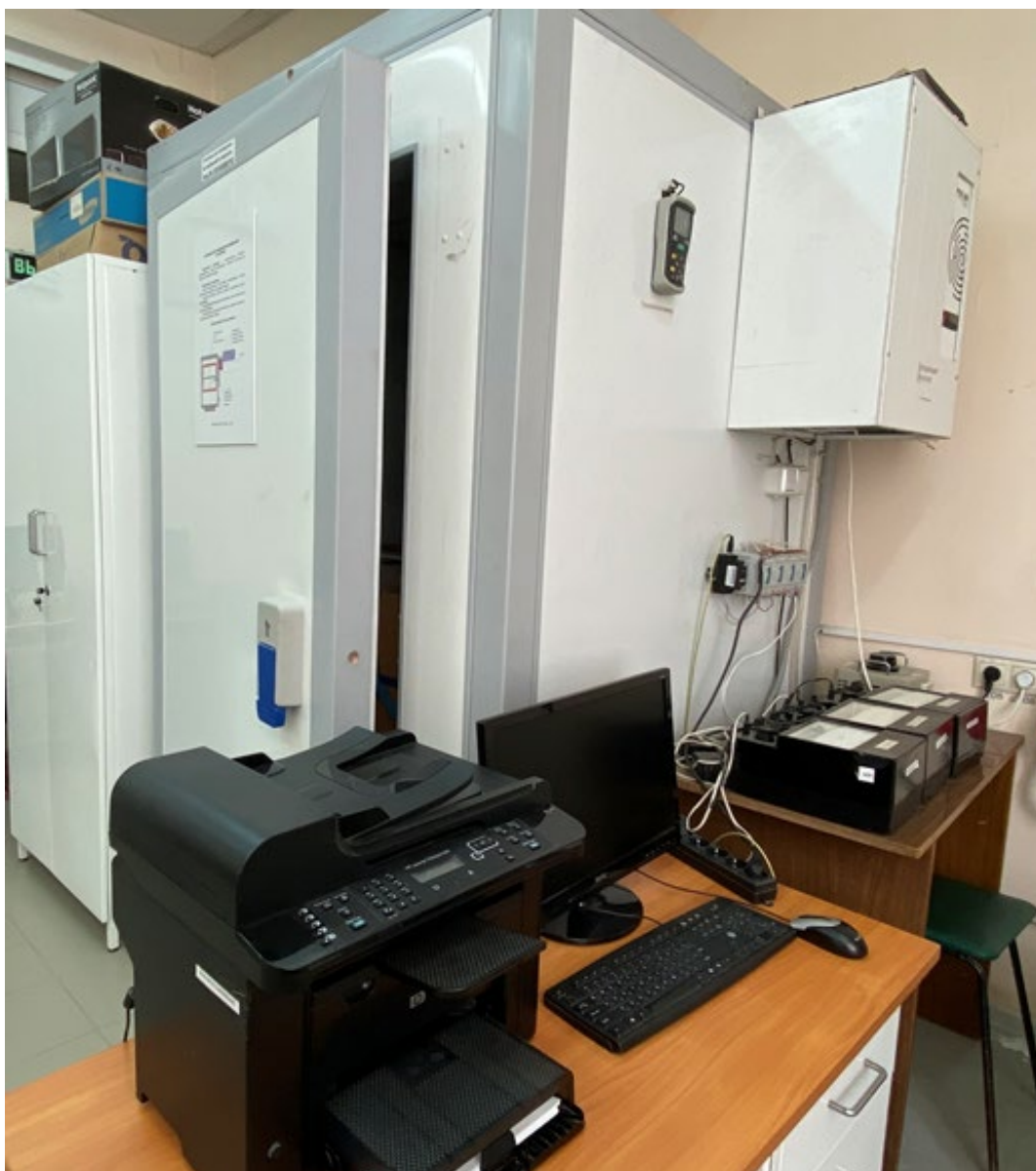
Рисунок 5.6 – Общий вид лабораторной установки для проведения исследований по мерзлоте
