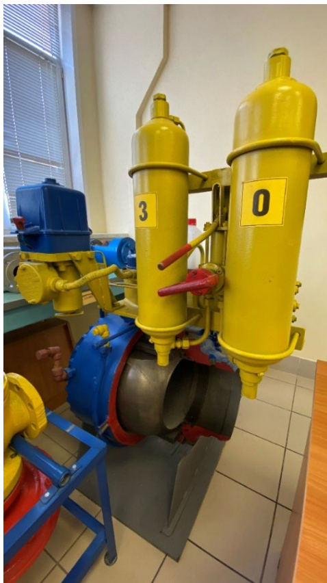
Рисунок 1.35 – Кран шаровой «Грове» в надземном исполнении (в комплекте) ДN = 300 мм
