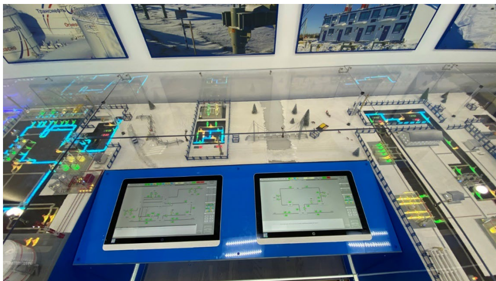
Рисунок 1.17 – Линейная часть с пунктом подогрева нефти между головной и промежуточной нефтеперекачивающими станциями на первом технологическом участке
