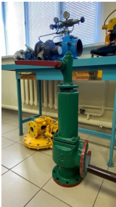
Рисунок 1.33 – а) Регулятор давления газа типа РДБК1-50, РДБК1П-50, РДБК1-100, РДБК1П-100 и Клапан предохранительный пружинный (КПП); б) Регулятор давления газа типа РДБК1-25Н(В), РДБК1-50Н(В), РДБК1-100Н(В), РДБК1-200Н(В)
