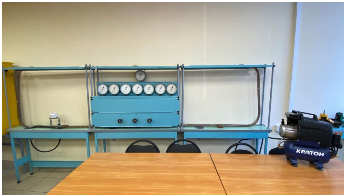
Рисунок 1.30 – Установка, предназначенная для моделирования работы участка магистрального газопровода
