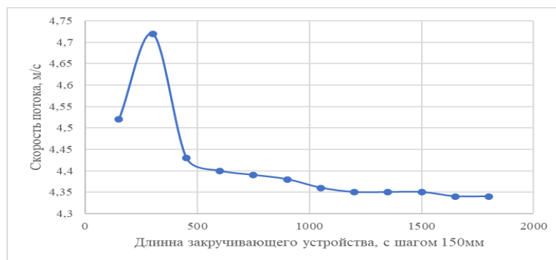
Рисунок 3.34 – График зависимости изменения скорости потока на конце закручивающего устройства от его длины с шагом 150 мм
