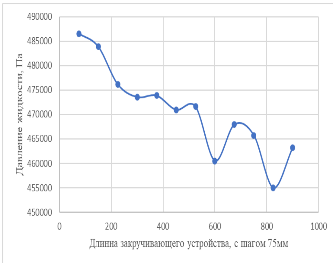
Рисунок 3.27 – График зависимости изменения давления жидкости на конце закручивающего устройства от его длины с шагом 75 мм
