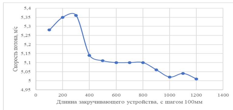
Рисунок 3.30 – График зависимости изменения скорости потока на конце закручивающего устройства от его длины с шагом 100 мм
