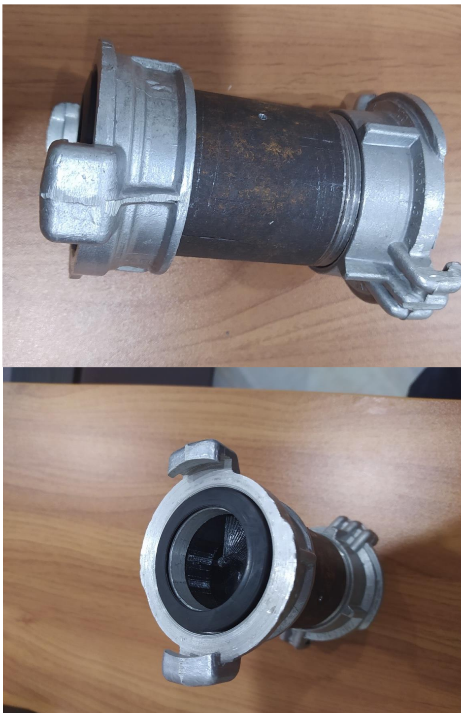
Рисунок 4.4 – Опытная сборка закручивающего устройства
