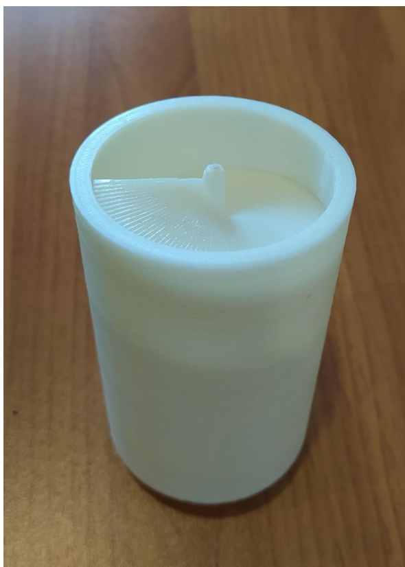
Рисунок 4.3 – Опытный образец закручивающего устройства
