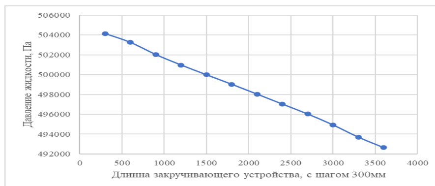
Рисунок 3.39 – График зависимости изменения давления жидкости на конце закручивающего устройства от его длины с шагом 300 мм
