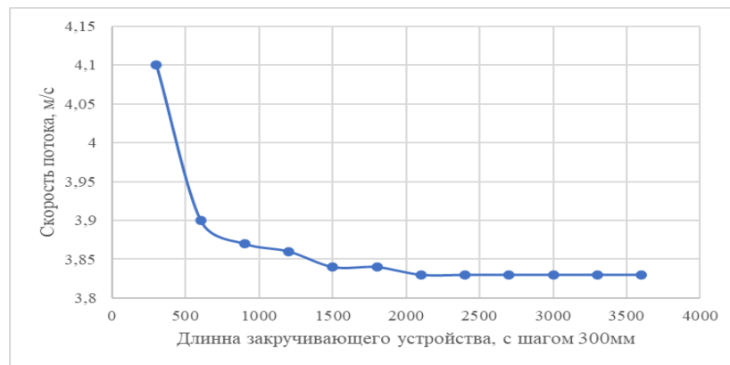
Рисунок 3.38 – График зависимости изменения скорости потока на конце закручивающего устройства от его длины с шагом 300 мм
