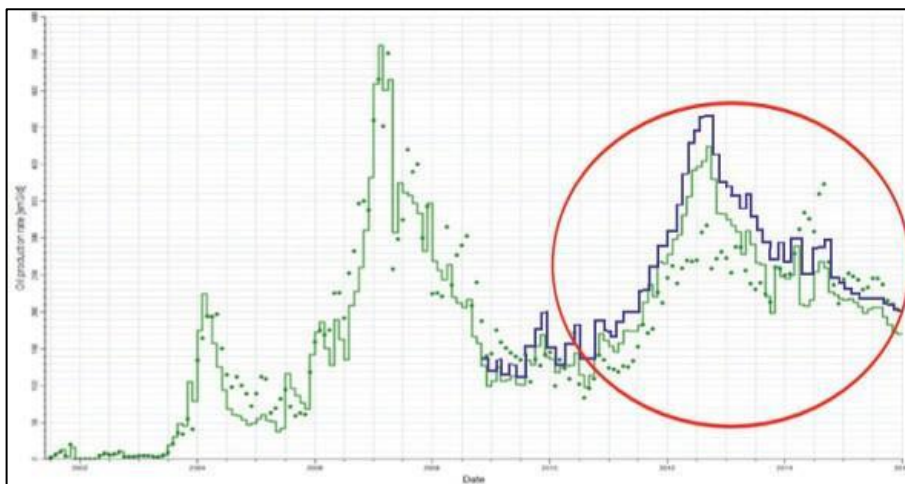
Рисунок 4.3 – Результаты расчета дебита нефти на трехмерной модели
