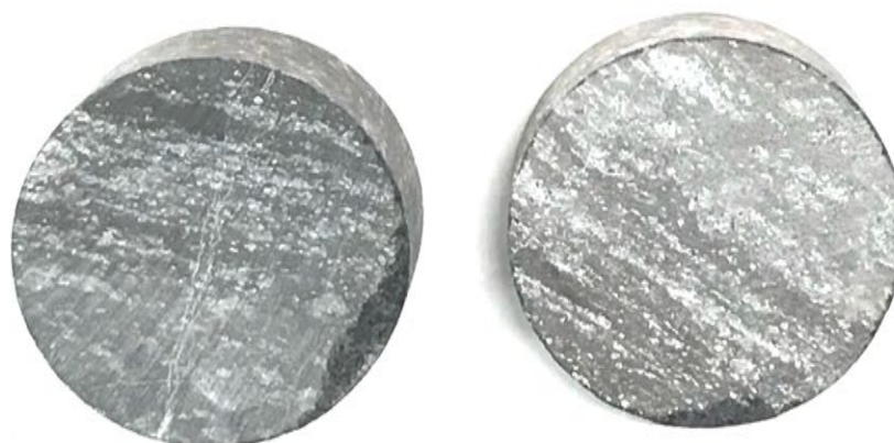
Рисунок 3.1 — Керновый материал скважины № 150. Интервал отбора 1575,10 м. Вид сверху
