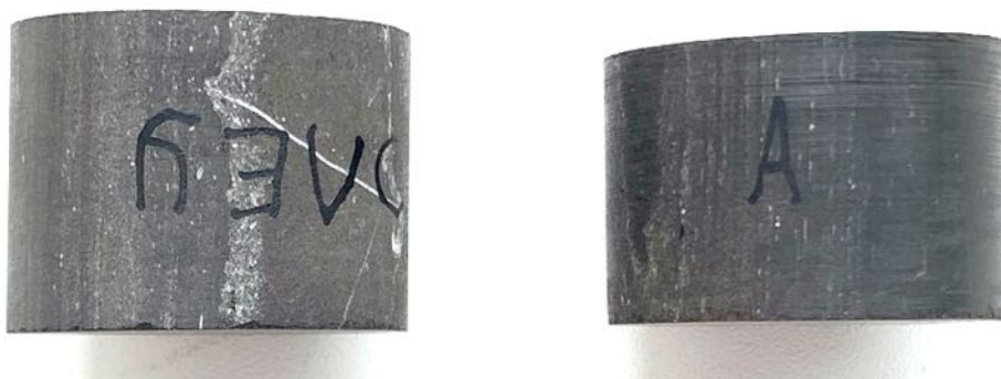
Рисунок 3.31 — Керновый материал скважины № 910. Интервал отбора 2112,30 м. Вид слева
