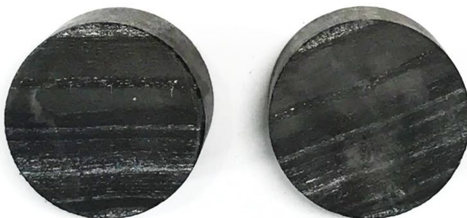
Рисунок 3.5 — Керновый материал скважины № 150. Интервал отбора 1578,05 м. Вид сверху
