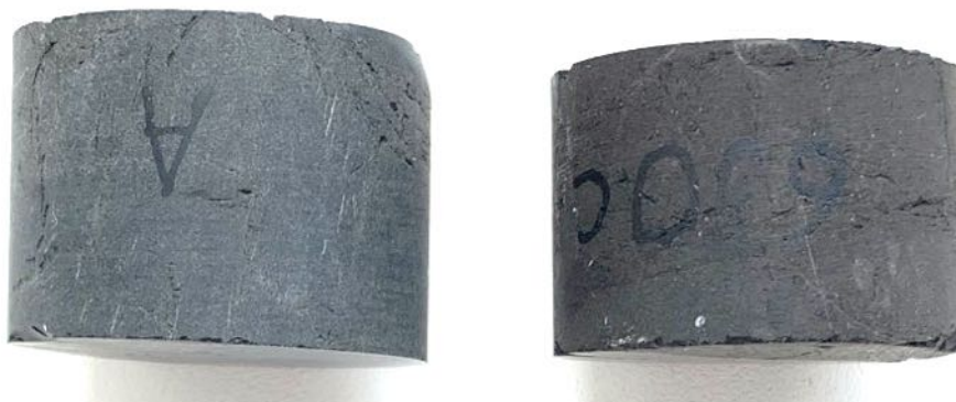
Рисунок 3.39 — Керновый материал скважины № 630. Интервал отбора 2396 м. Вид слева
