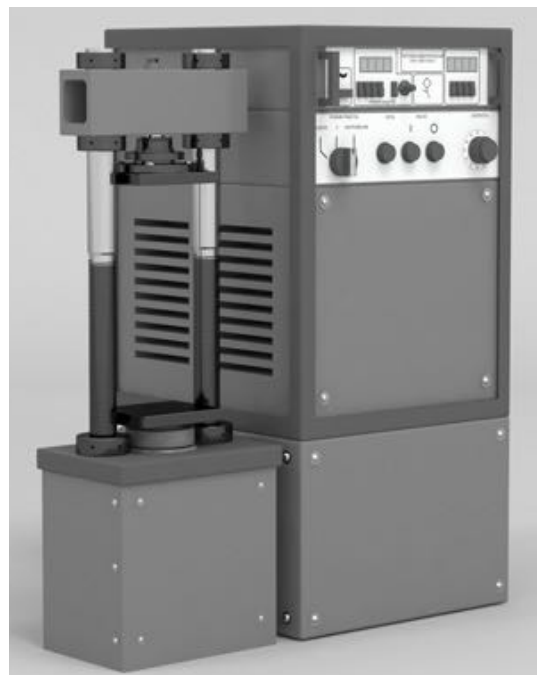
Рисунок 3.41 — Внешний вид испытательного пресса ИП-100
