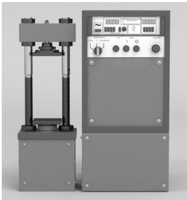
Рисунок 3.41 — Внешний вид испытательного пресса ИП-100
