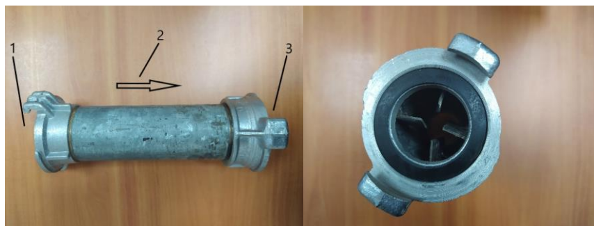
1 – вход в лопастную часть трубного пространства; 2 – направление потока жидкости; 3 – выход из трубного пространства
