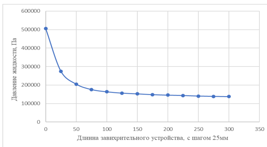
Рисунок 14 – График зависимости изменения давления жидкости на конце закручивающего устройства от количества витков с шагом 25 мм
