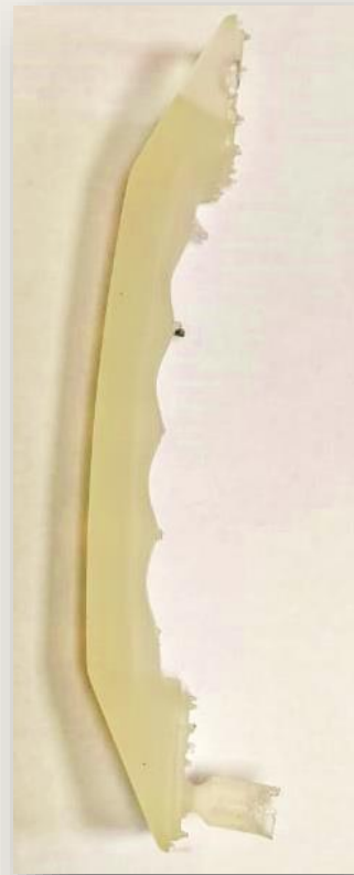
Силиконовая форма и прототип дверной ручки из двухкомпонентного реактопласта
