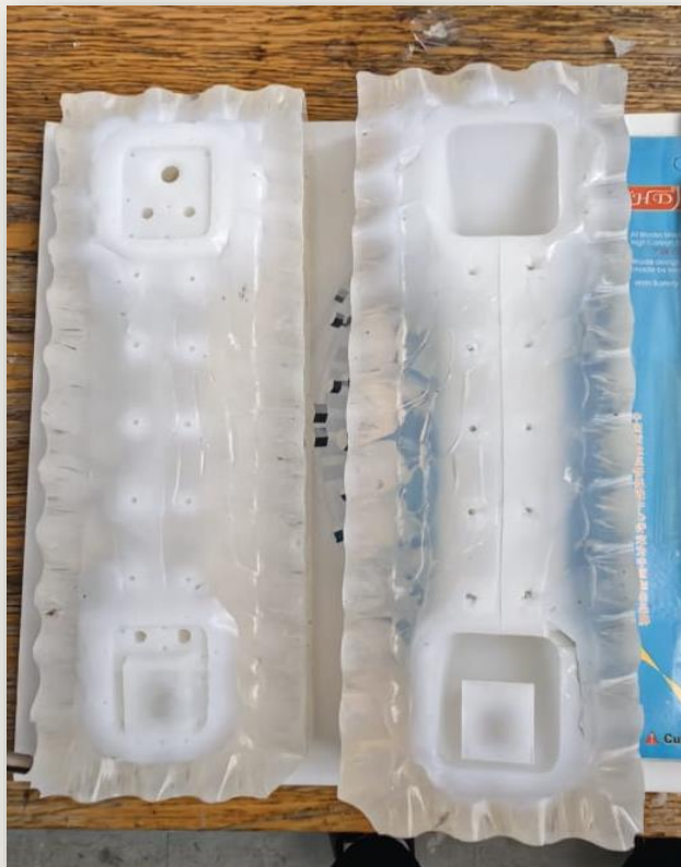
Силиконовая форма и прототип дверной ручки из двухкомпонентного реактопласта
