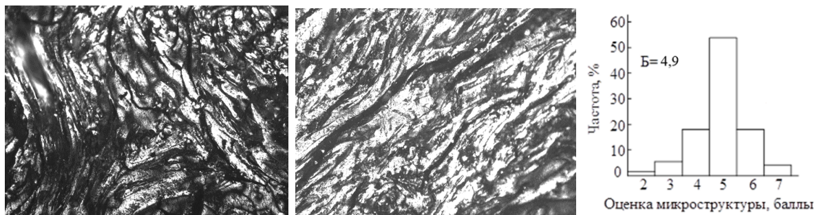
Рисунок 4.1 – Распределение структурных составляющих в коксе из исходного декантоя и оценка микроструктуры кокса (при температуре 500 °С, давлении - 0,3 МПа, производительности - 1,3 л/час)
