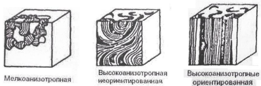
Рисунок 1.6 - Направленность структуры электродного кокса
