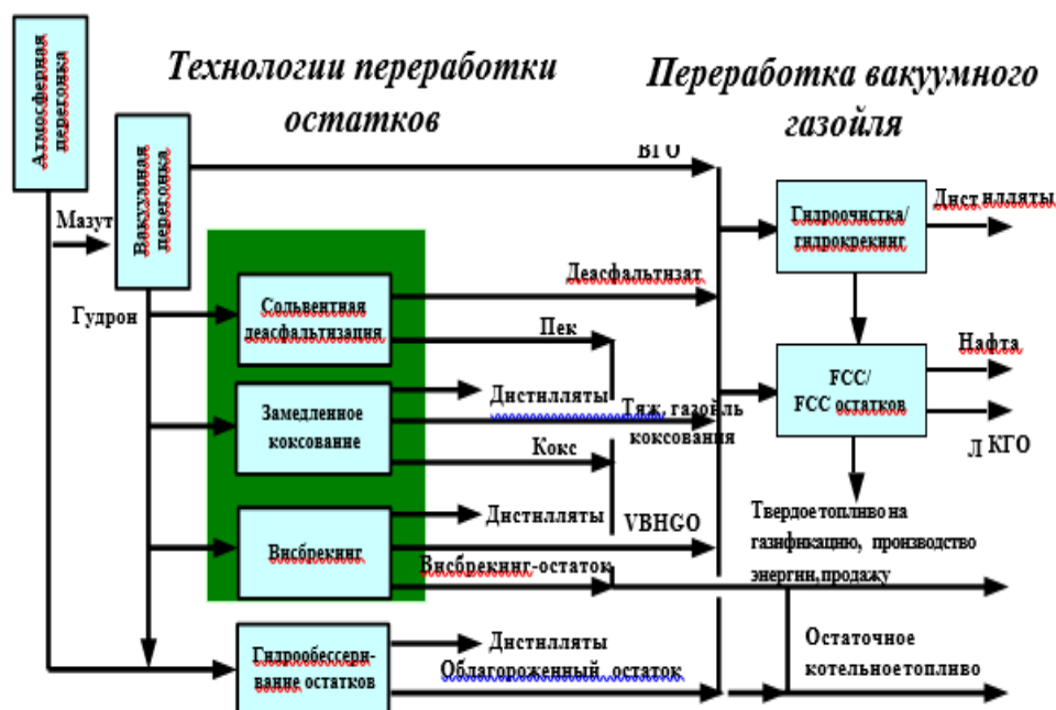
Рисунок 1.2 - Принципиальная схема вариантов переработки тяжелых нефтяных остатков [11]
