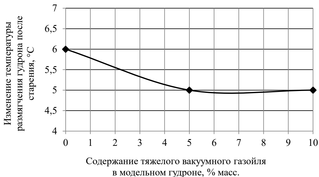
Рисунок 3.1 – Зависимость изменения температуры размягчения модельного гудрона после старения от содержания тяжелого вакуумного газойля в гудроне III
