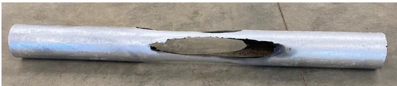
Рисунок 2.2 – Четыре «окна», полученные при фрезеровании обсадной трубы на стенде, каждое окно длиной 0,65 м
