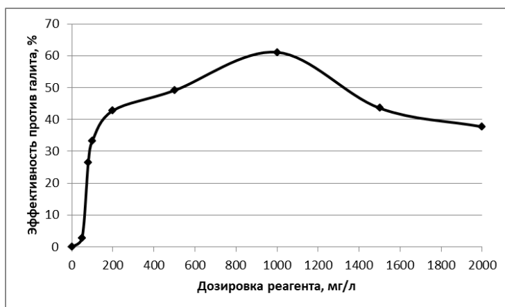
Рисунок 3.2 – Эффективность ингибирования галита в зависимости от дозировки разработанного реагента
