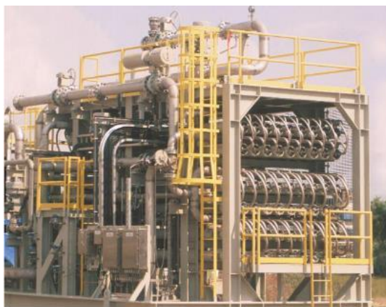
Рисунок 1.3 – Один из семи модулей для сепарирования сульфатов, способный производить 350,000 баррелей морской воды с низким содержанием сульфат ионов для Kizomba А месторождения в Западной Африке
