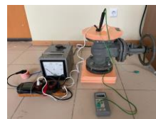
1 – Лабораторный автотрансформатор (ЛАТР); 2 – Ваттметр; 3 – Нагревательный прибор; 4 – Задвижка DN80; 5 – Термодатчики; 6 – Электронный термометр ETI
