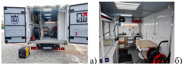
Рисунок 2 Мобильная лаборатория для безреагентного удаления твердых солевых отложений на базе автомобиля «Газель-Некст»: а) общий вид лаборатории снаружи; б) внутри лаборатории
