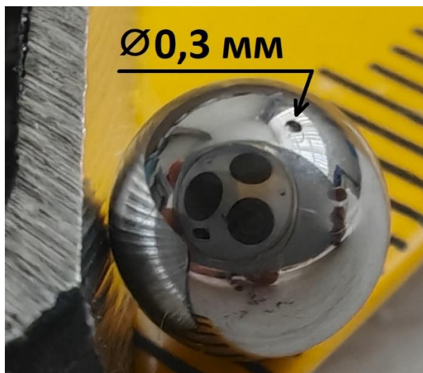
Рисунок 1 – Пример дефекта \varnothing 0,3 мм на шарике \varnothing 5,556 мм
