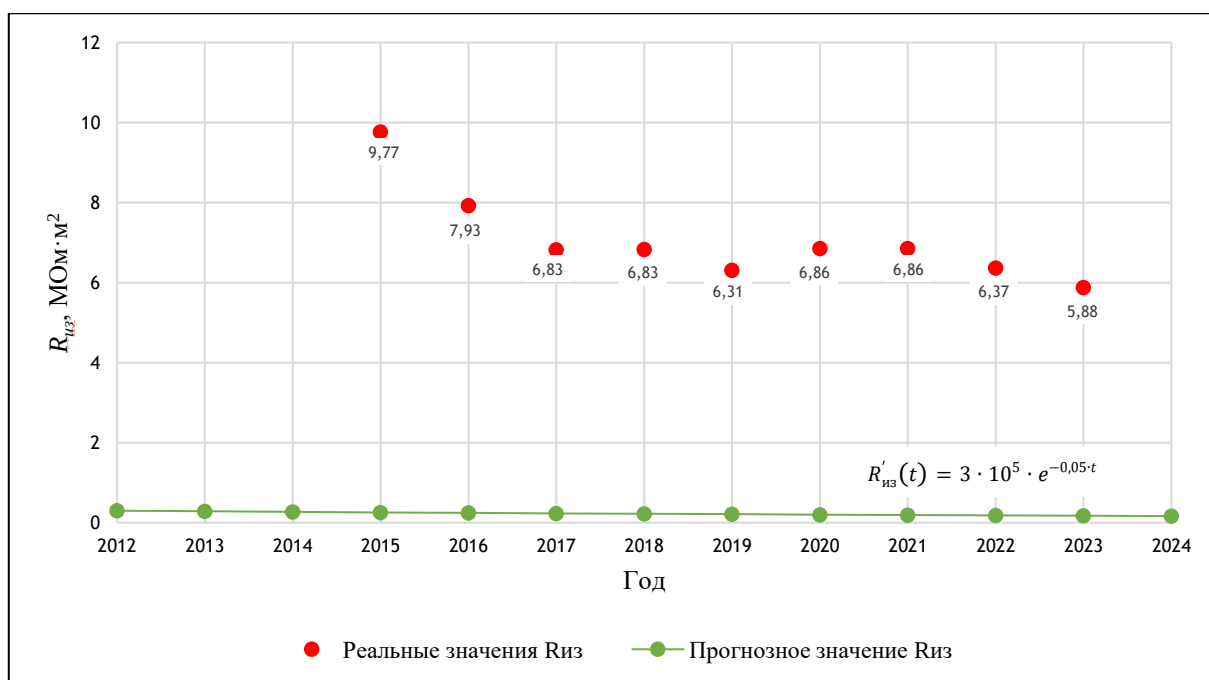
Рисунок 1 – Результат сравнения реальных и прогнозных значений сопротивления защитного покрытия трубопровода с течением времени в период с 2015 по 2023 гг.
