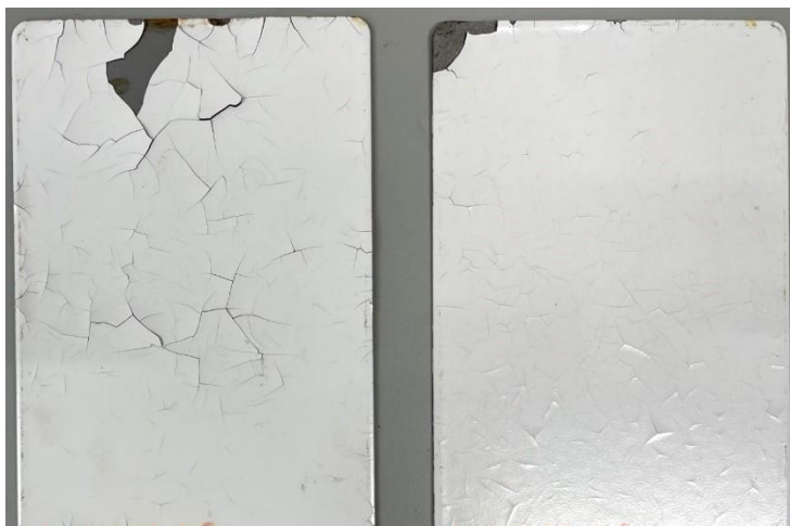
Рисунок 2 – Внешний вид образца после длительных испытаний
