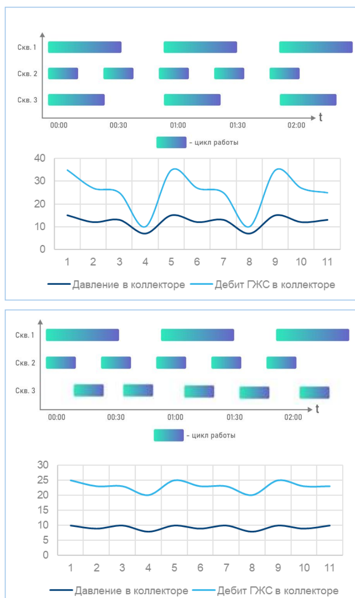
Рисунок 3 – Пример оптимизации циклов запусков-остановок: сверху – ДО оптимизации, снизу – ПОСЛЕ оптимизации
