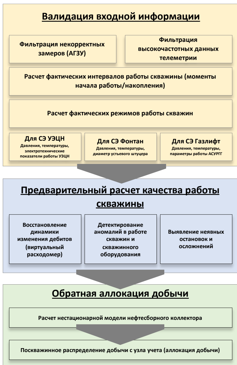
Рисунок 16 – Взаимосвязь решенных задач в области автоматического анализа данных высокочастотной телеметрии
