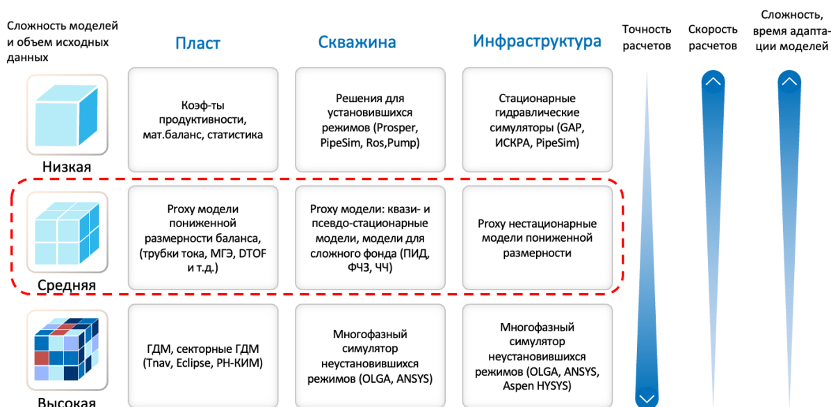
Рисунок 9 – Иерархия моделей для разработки инструментов принятия решений
