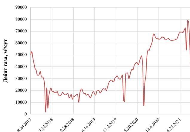
Рисунок 4 – Динамика дебита газа для подгазовой горизонтальной скважины (слева); характеристика работы скважины с фонтанированием через затруб (справа): насос является штуцером потока - отрицательный перепад давления на насосе и на напорно-расходной характеристике
