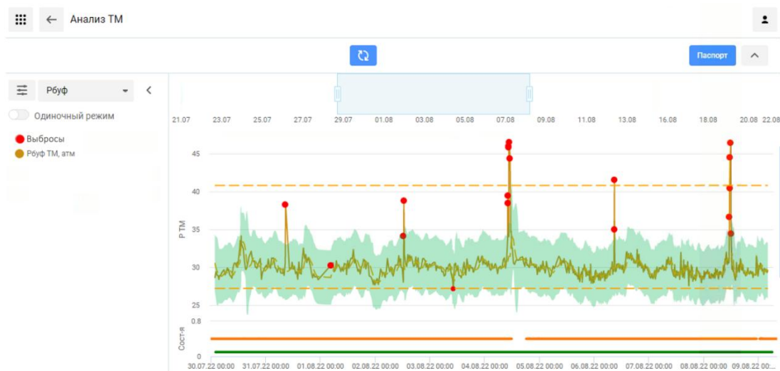
Рисунок 19 – Пример работы статистического подхода к верификации данных для буферного давления скважины (данные телеметрии)
