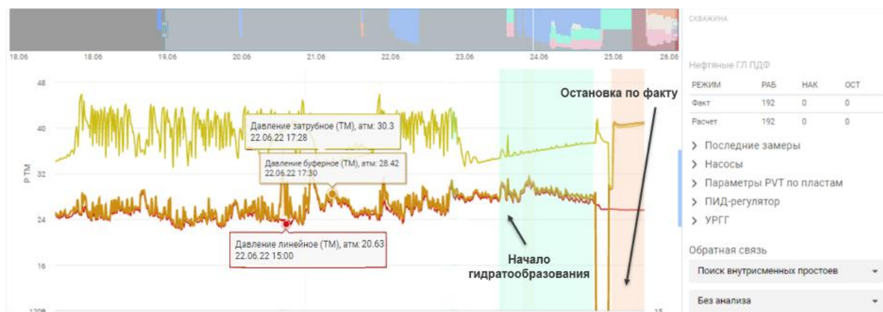
Рисунок 21 – Визуализация результатов работы модуля по выявлению ВСП (данные телеметрии)
