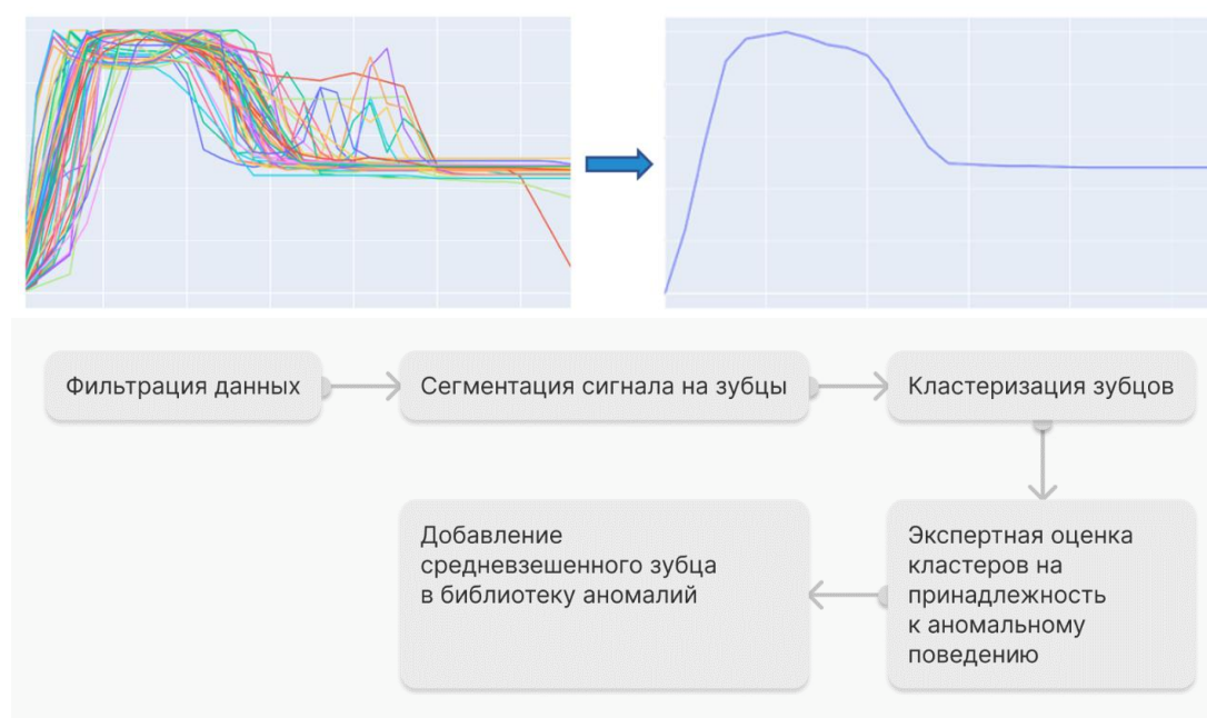
Рисунок 23 – Пример занесения осредненного аномального кластера в библиотеку аномалий и блок-схема формирования библиотеки аномалий
