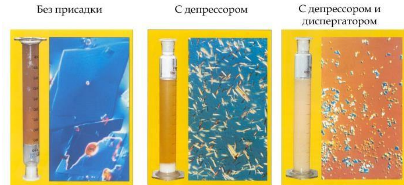
Рисунок 1.10 – Действие депрессора совместно с диспергатором
