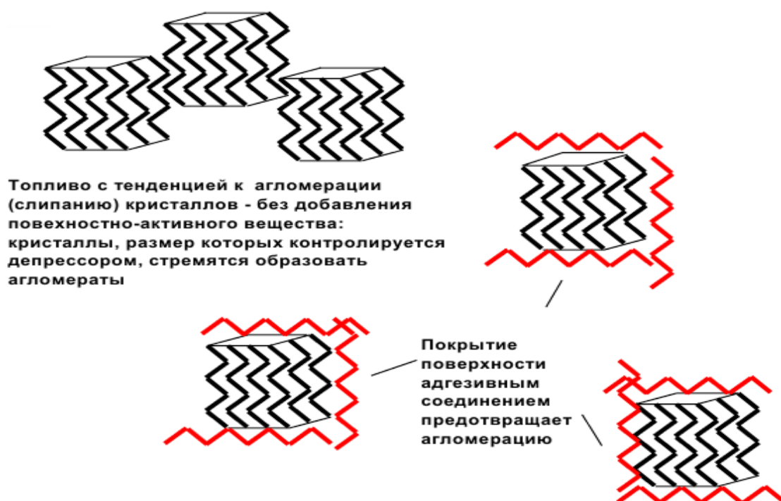
Рисунок 1.7 – Модель взаимодействия депрессора с ДТ по адсорбционной теории
